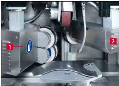
**Figure 3-16** Unités de polissage avec pâte de polissage
