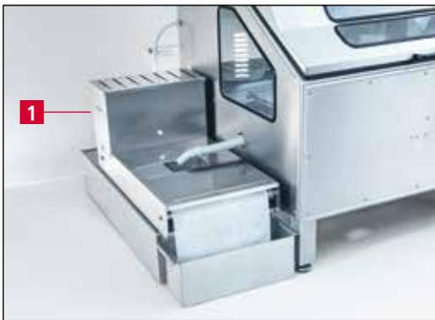
**Figure 6-1** Installation de liquide de refroidissement à bande filtrante
