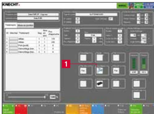
Figure 9-3 Activation/désactivation de la pompe de liquide de refroidissement
