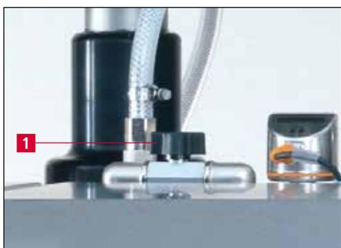
**Figure 3-10** Robinet de liquide de refroidissement
