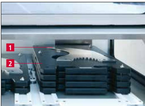
Figure 7-7 Couteaux sur plaques de support
