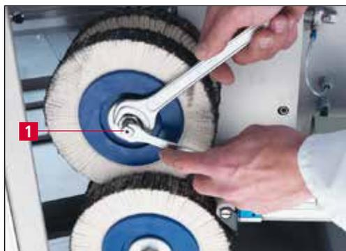
**Figure 7-17** Remplacer la brosse à lamelle de l'unité de démorfilage
