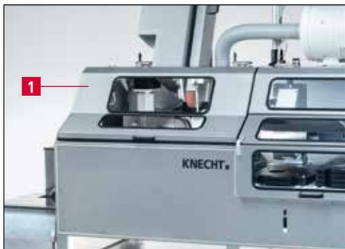
**Figure 3-11** Capot de protection zone d'affûtage
