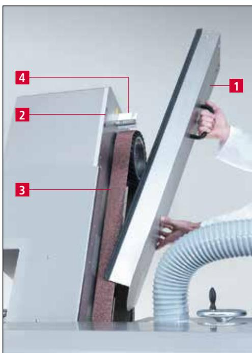
Figure 7-13 Remplacer la bande d'affûtage
