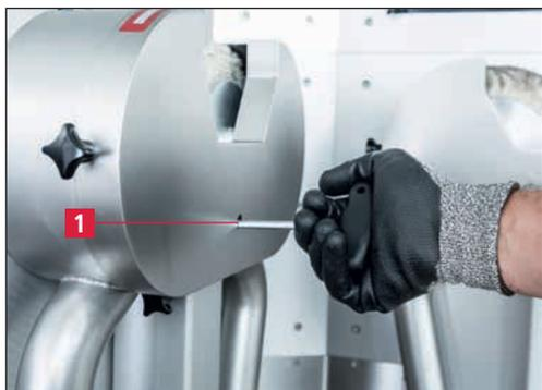
**Figure 7-21** Ajuster les disques de polissage / démorfilage
