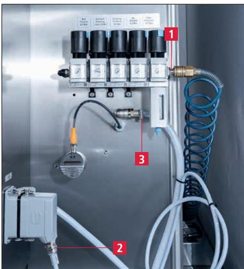
Figure 6-2 Raccord d'air comprimé
