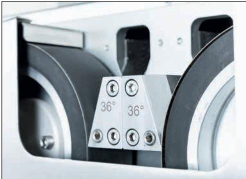
Figure 7-11 Régler les bandes d'affûtage à eau
