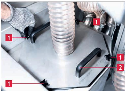
Figure 9-4 Fermeture de l'unité d'aspiration
