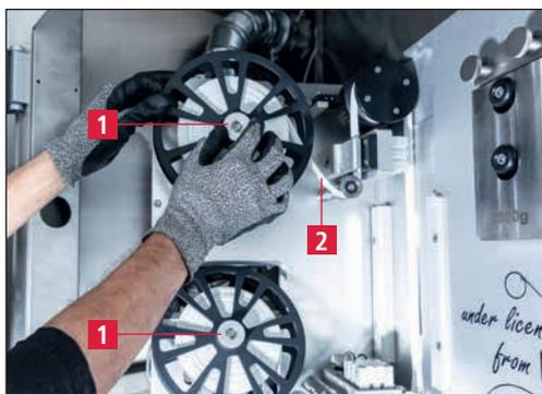
Figure 7-23 Retirer le fil de test
