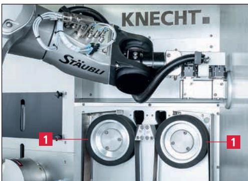
Figure 7-7 Remplacer la bande d'affûtage à eau
