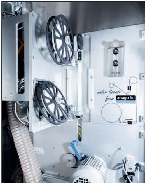
Figure 7-22 Ouvrir l'unité de mesure du tranchant
