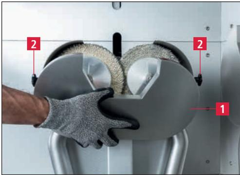
Figure 7-18 Retirer le capot de protection
