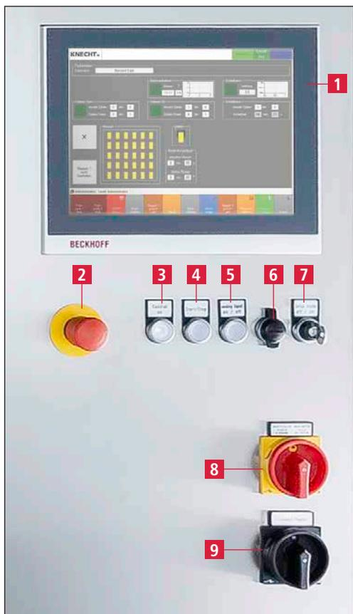
Figure 3-5 Pupitre de commande de l'affûteuse
