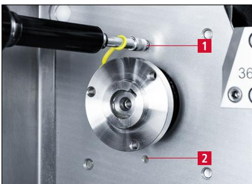
Figure 9-2 Lubrification du moteur de la bande d'affûtage
