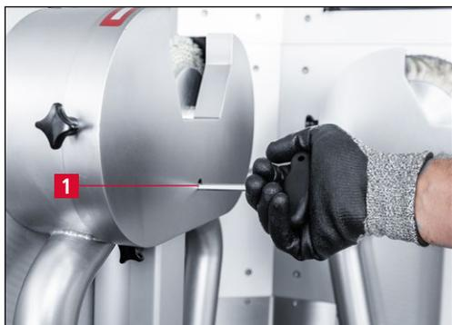
**Figure 7-20** Ajustement des disques de polissage/démorfilage
