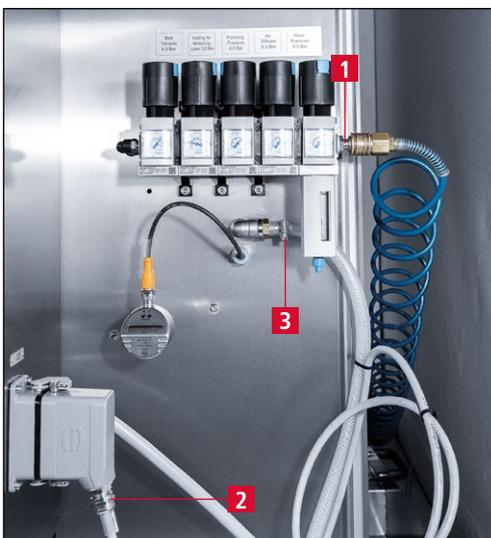
Figure 6-2 Raccord d'air comprimé
