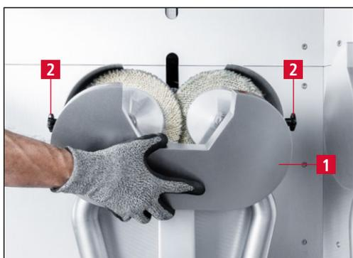
**Figure 7-17** Dépose du capot de protection
