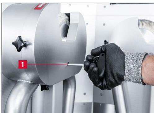
**Figure 7-16** Écartement des disques de polissage/démorfilage
