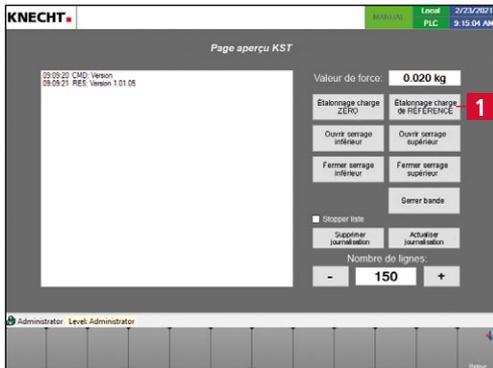
Figure 7-29 Étalonnage de la «charge de RÉFÉRENCE»
