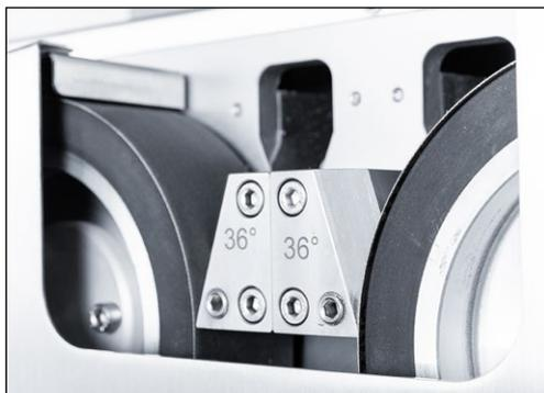
Figure 7-9 Réglage des bandes d'affûtage à eau
