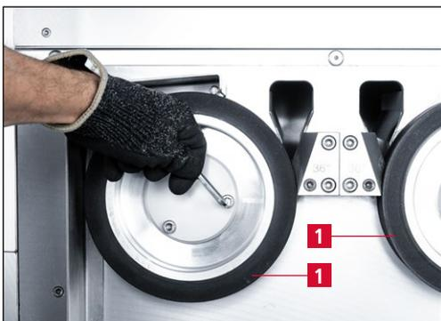
Figure 9-1 Démontage des disques de contact
