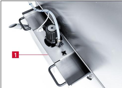
Figure 6-1 Réservoir d'eau
