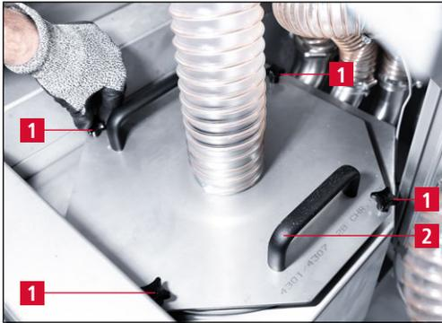
Figure 9-9 Fermeture de l'unité d'aspiration
