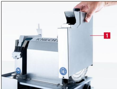
**Figure 7-12** Retirer le capot du disque de polissage
