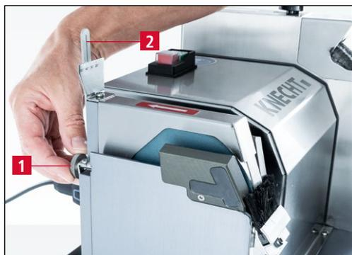
Pour régler l'angle d'affûtage, desserrer l'écrou moleté (7-1/1).
