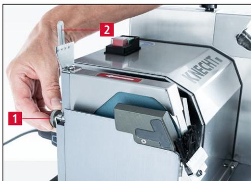
Figure 7-1 Régler l'angle d'affûtage
