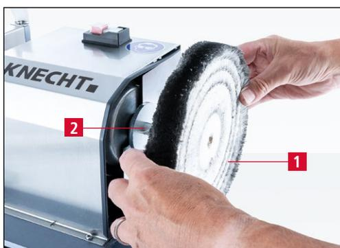
**Figure 7-14** Remplacer le disque de polissage
