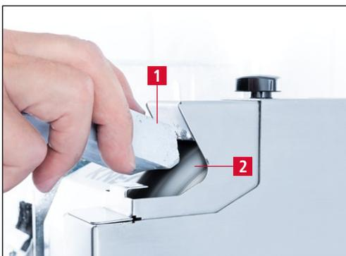
Figure 7-4 Appliquer la pâte de polissage
