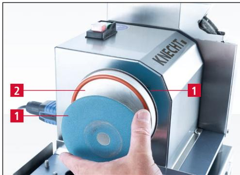
**Figure 7-8** Retirer les disques d'affûtage usagés
