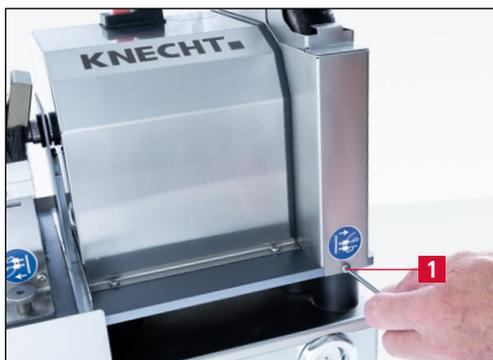
Figure 7-11 Dévisser le capot du disque de polissage
