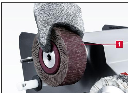
**Figure 6-4** Retirer la roue à lamelles
