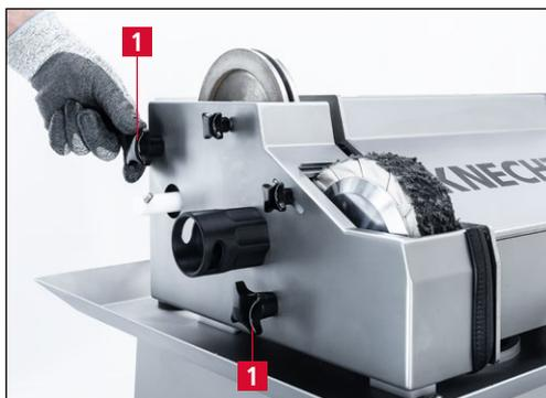
Figure 7-8 Retirer le capot de protection
