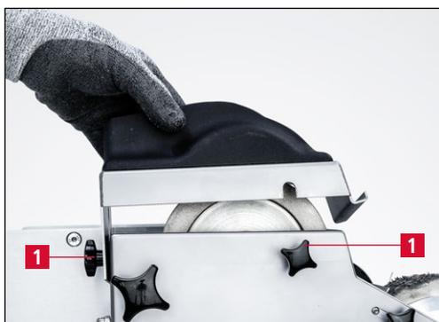
Figure 7-7 Retirer le dispositif d'affûtage
