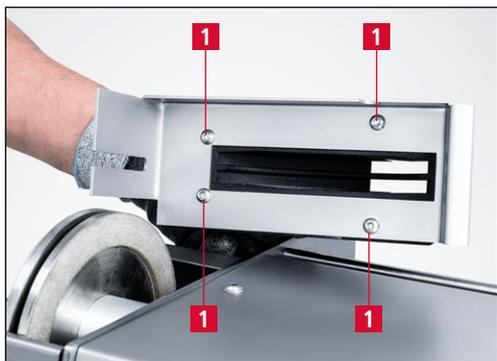
**Figure 6-18** Aligner le capot du guide-lame
