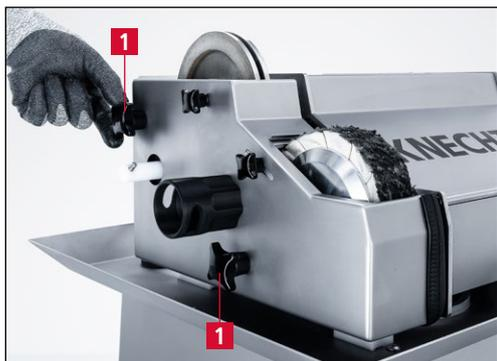
Figure 6-12 Monter le capot de protection
