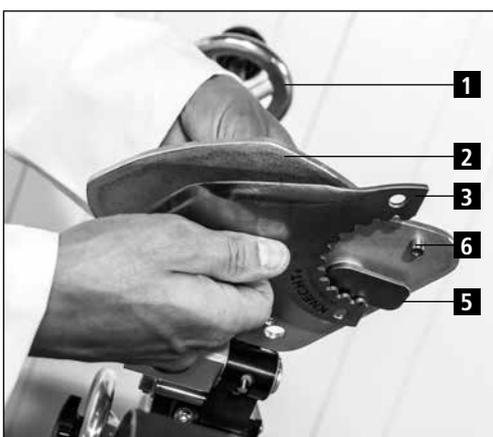
Figure 7-5 Serrer le couteau de cutter sur le support d'affûtage
