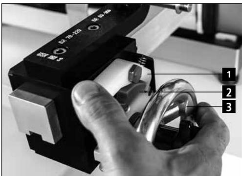
Figure 7-7 Tourner le volant sur la première position d'arrêt
