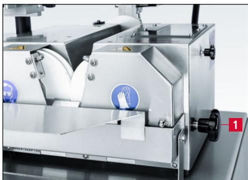
**Figure 7-94** Position de remplacement des disques d'affûtage
