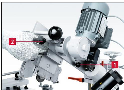
Figure 7-51 Serrage du support pour couteaux circulaires
