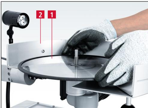
**Figure 7-15** Placement du couteau circulaire sur le support pour couteaux circulaires
