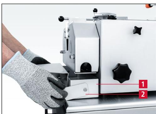
Figure 7-91 Dépose de la coupelle d'eau
