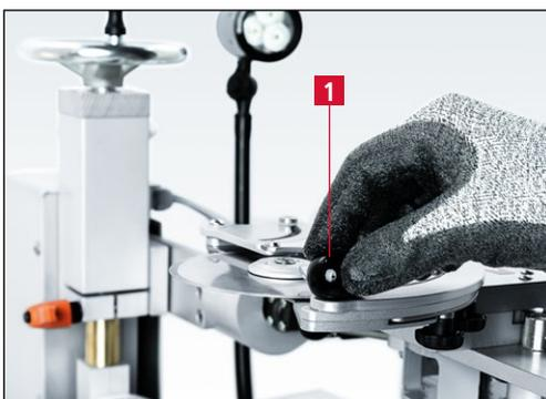
**Figure 7-59** Fermeture de la vitre de protection
