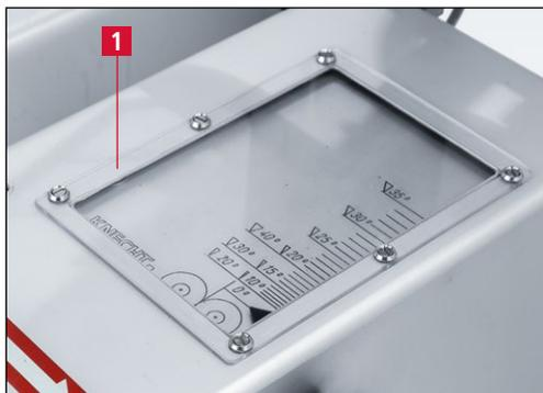
Figure 3-3 Échelle graduée d'angle
