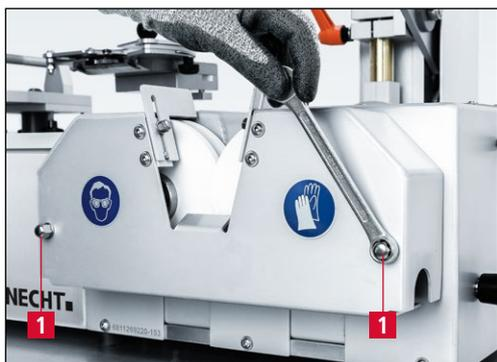
Figure 7-92 Dévissage des écrous borgnes
