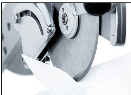
**Figure 7-75** Contrôle de l'affûtage du couteau
