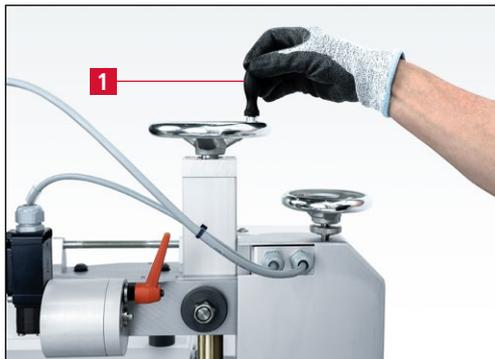
**Figure 7-66** Approcher les couteaux circulaires des disques d'affûtage
