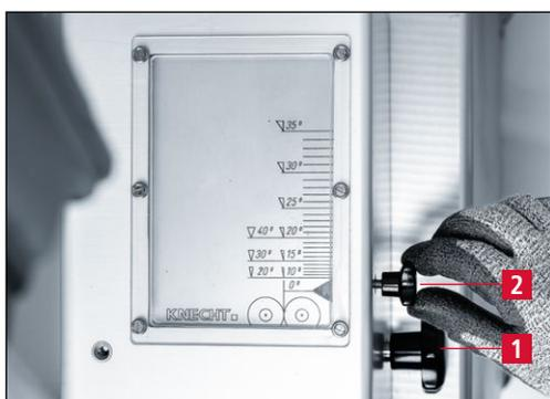
Figure 7-47 Réglage de l'angle d'affûtage
