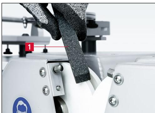
**Figure 7-89** Arrondissement des arêtes des disques d'affûtage
