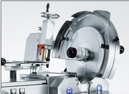
Figure 7-41 Inclinaison du dispositif d'affûtage
