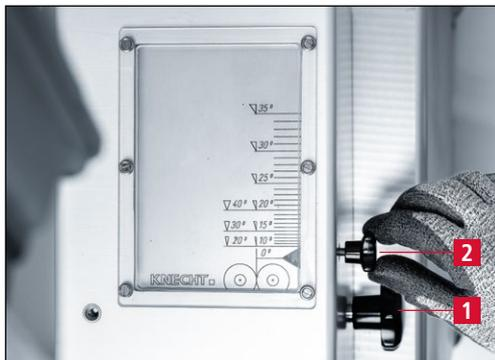
Figure 7-4 Réglage de l'angle d'affûtage
