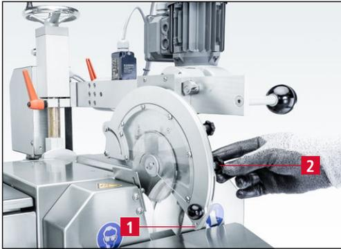
Figure 7-69 Réglage des coulisseaux de sécurité
