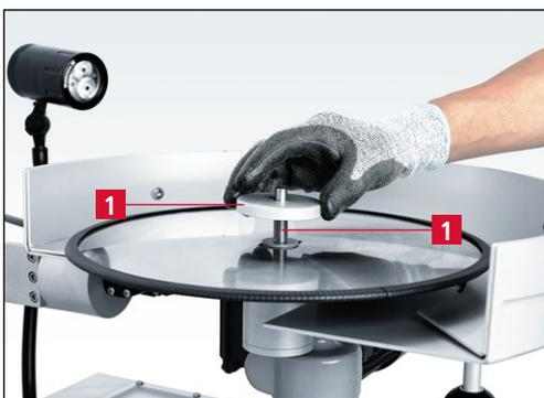
**Figure 7-16** Enfichage de la bride de serrage sur le boulon de réception
