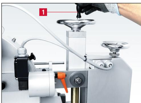
**Figure 7-25** Approcher les couteaux circulaires des disques d'affûtage
