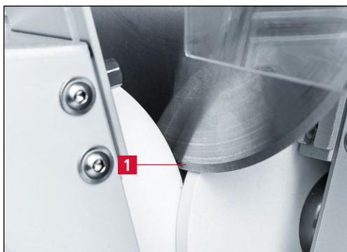
**Figure 7-27** Couteaux éloignés des disques d'affûtage
