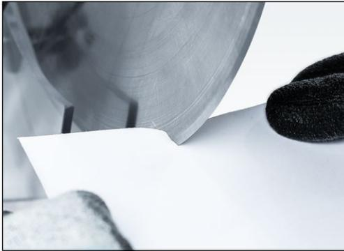
**Figure 7-34** Contrôle de l'affûtage du couteau
