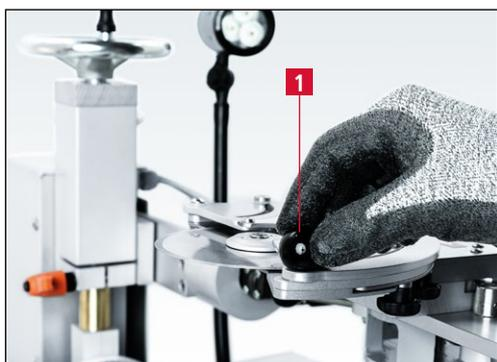
**Figure 7-78** Ouverture de la vitre de protection
