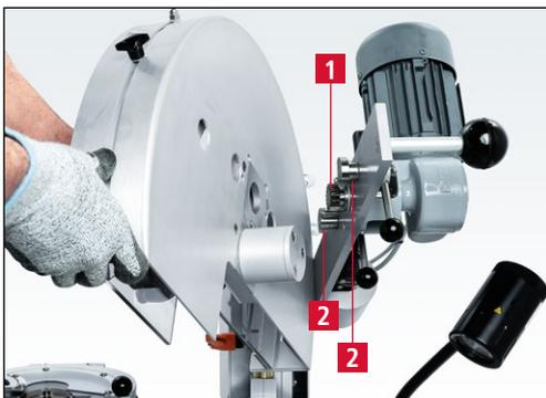
Figure 7-7 Montage du support pour couteaux circulaires
