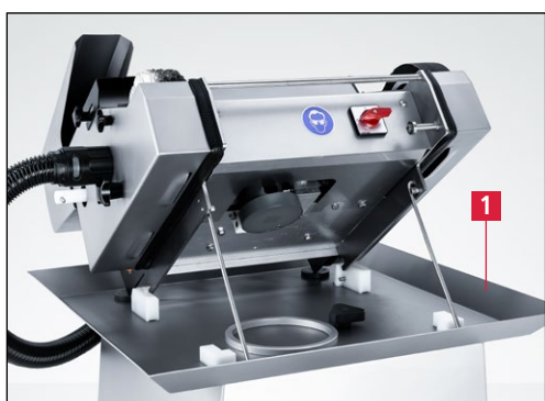
Figure 6-1 Remplissage du réservoir d'eau
