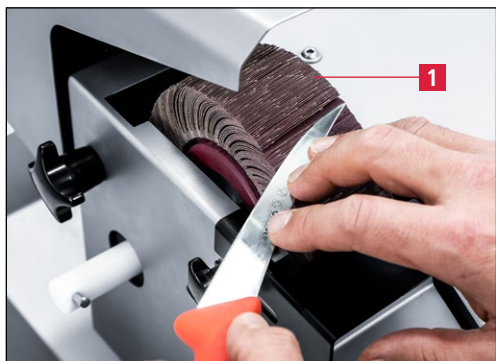
Figure 7-3 Affûtage fin du couteau à main
