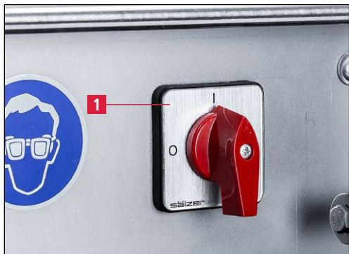
Figure 7-36 Mise en marche de l'affûteuse
