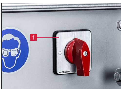
Figure 7-44 Mise en marche de l'affûteuse
