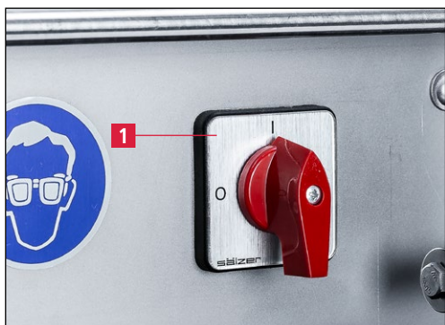
Figure 7-56 Mise en marche de l'affûteuse
