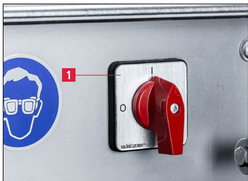
Figure 7-17 Mise en marche de l'affûteuse
