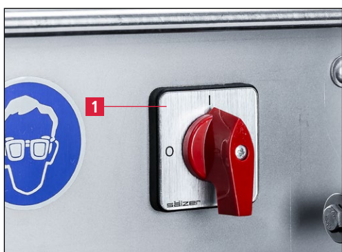
Figure 6-2 Mise en marche de l'affûteuse
