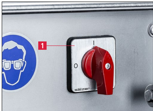
Figure 7-1 Mise en marche de l'affûteuse
