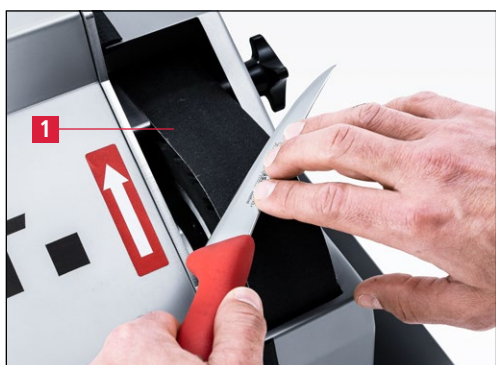
Figure 7-2 Pré-affûtage du couteau à main
