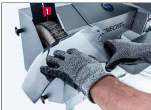
**Figure 7-14** Polissage/démorfilage du couteau de cutter
