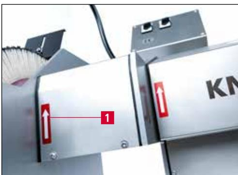
Figure 6-2 Contrôler le sens de rotation
