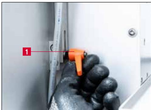
**Figure 6-5** Levier de blocage de l'échelle angulaire
