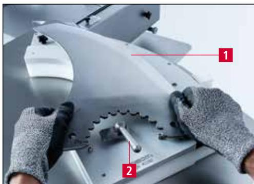
Figure 7-4 Fixation du couteau de cutter
