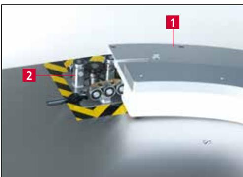
**Figure 7-2** Montage du gabarit de fixation
