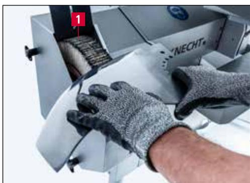
**Figure 7-10** Polissage/démorfilage du couteau de cutter
