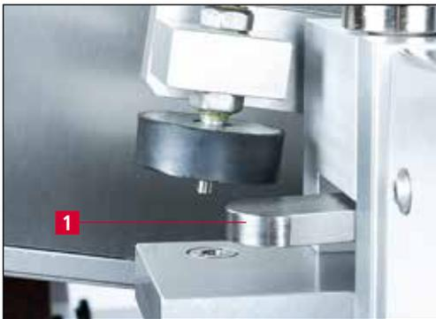
**Figure 7-5** Pivotement du groupe d'affûtage en position de travail
