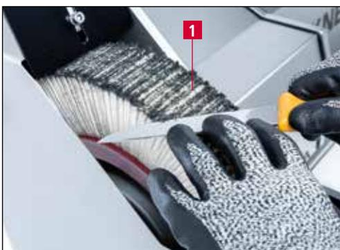
Figure 7-16 Polissage du couteau à main
