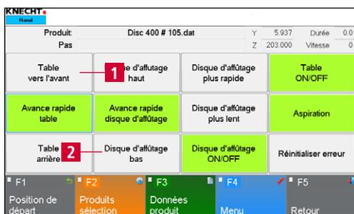
**Figure 8-15** Amener la table et le disque d'affûtage en position de travail
