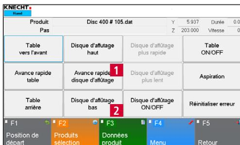
Figure 7-9 Dressage d'un disque d'affûtage
