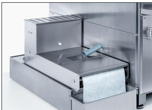
**Figure 6-1** Remplir le dispositif de liquide de refroidissement avec filtre passe-bande
