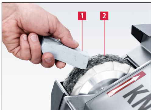
Εικόνα 7-20 Επάλειψη πολλού στίλβωσης
