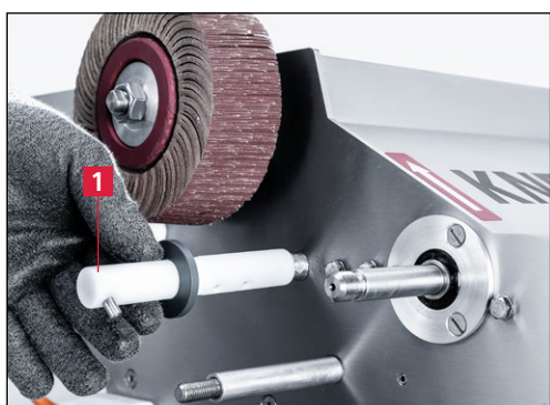
Εικόνα 7-29 Τοποθέτηση ακροφυσίου νερού
