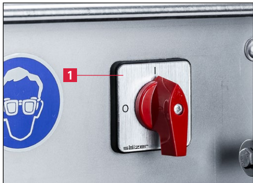
Εικόνα 7-1 Ενεργοποίηση μηχανής λείανσης
