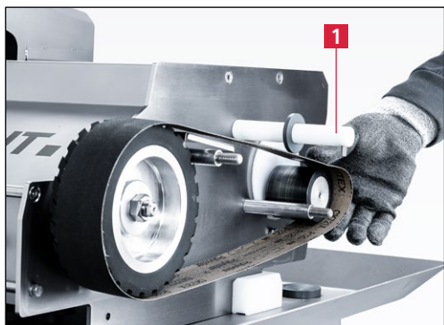
Εικόνα 7-41 Τοποθέτηση ιμάντα λείανσης
