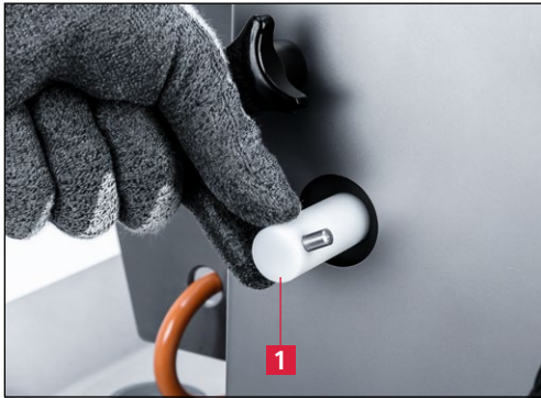
Εικόνα 7-63 Λεπτομερής ρύθμιση της παροχής ψυκτικού υγρού
