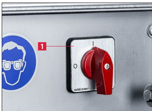
Εικόνα 7-56 Ενεργοποίηση μηχανής λείανσης
