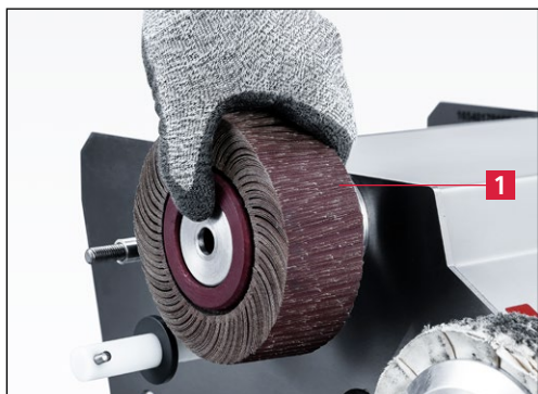
Εικόνα 7-53 Αφαίρεση τροχού λείανσης με λάμες και αντικατάστασή του με νέο
