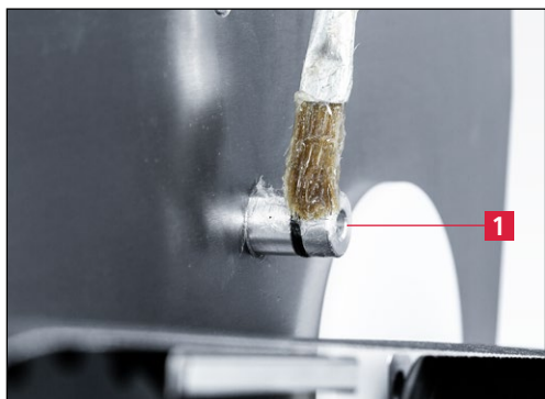
Εικόνα 7-60 Λίπανση στομίου ψυκτικού υγρού
