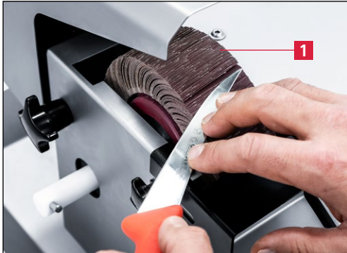
Εικόνα 7-3 Λεπτή λείανση μαχαιριού χειρός
