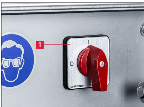
Εικόνα 7-62 Ενεργοποίηση μηχανής λείανσης
