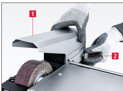
Εικόνα 7-22 Αφαίρεση προστατευτικού εκτόξευσης ρινισμάτων
