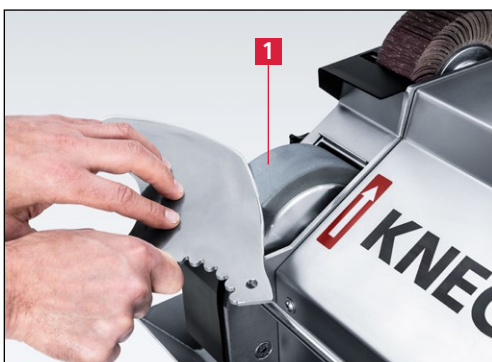
Εικόνα 7-38 Αφαίρεση γρεζιών του μαχαιριού στον δίσκο υγρής απόξεσης
