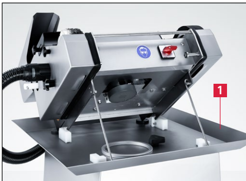
Εικόνα 6-1 Πλήρωση λεκάνης νερού
