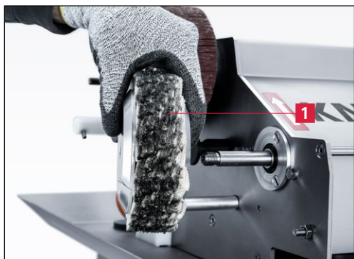
Εικόνα 7-49 Αφαίρεση δίσκου στίλβωσης και αντικατάστασή του με νέο
