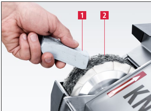
Εικόνα 7-4 Επάλειψη πολτού στίλβωσης
