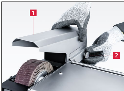
Εικόνα 7-46 Αφαίρεση προστατευτικού εκτόξευσης ρινισμάτων
