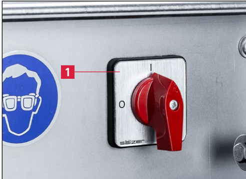
Εικόνα 7-36 Ενεργοποίηση μηχανής λείανσης
