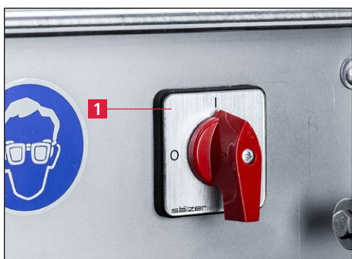
Εικόνα 7-44 Ενεργοποίηση μηχανής λείανσης
