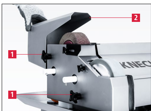
Εικόνα 7-35 Τοποθέτηση προστατευτικού καλύμματος και προστατευτικού εκτόξευσης ρινισμάτων
