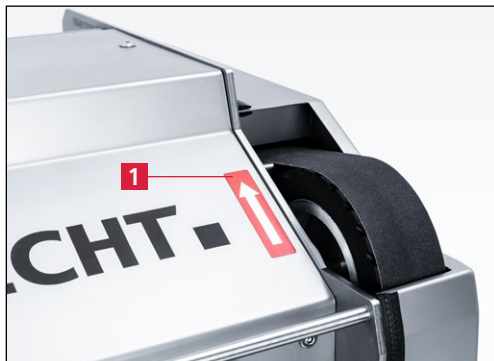
Εικόνα 6-3 Έλεγχος φοράς περιστροφής
