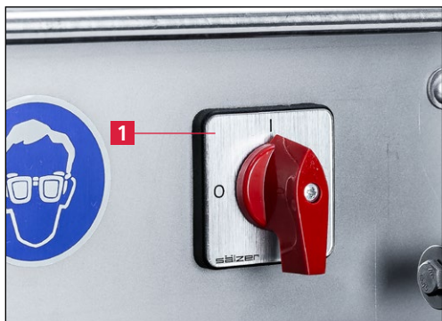
Εικόνα 7-17 Ενεργοποίηση μηχανής λείανσης
