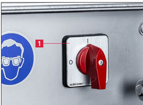
Εικόνα 6-2 Ενεργοποίηση μηχανής λείανσης
