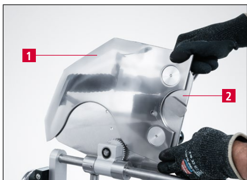
Slika 9-9 Pričvršćivanje noža na brusnu podlogu
