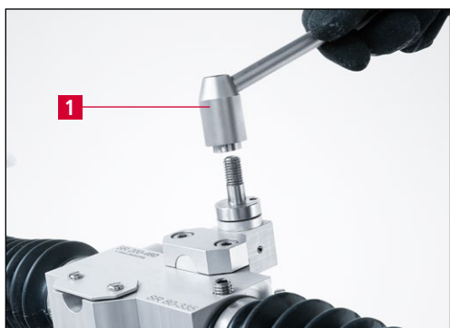
Slika 7-4 Uklanjanje poluge za pričvršćivanje
