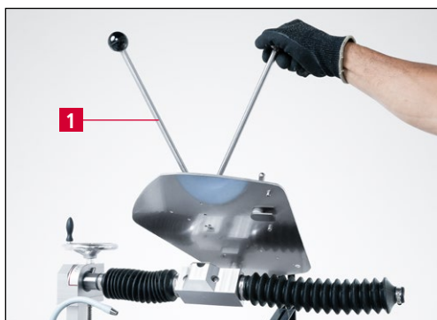
Slika 7-39 Zakretanje brusne podloge prema natrag
