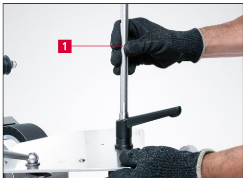
Slika 9-7 Pričvršćenje brusne podloge
