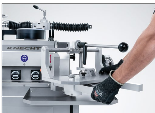
Slika 8-2 Zakretanje brusilice HV 262 u radni položaj
