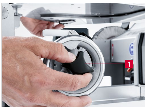
Slika 9-41 Otpuštanje križne ručke
