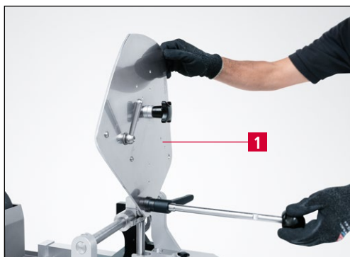
Slika 9-35 Zakretanje brusne podloge prema natrag u zaštitu od okretanja
