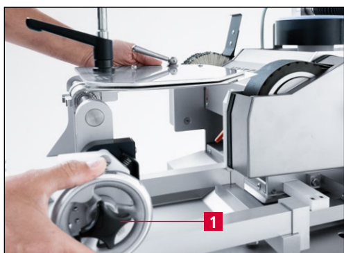
Slika 9-24 Vraćanje brusnog uređaja
