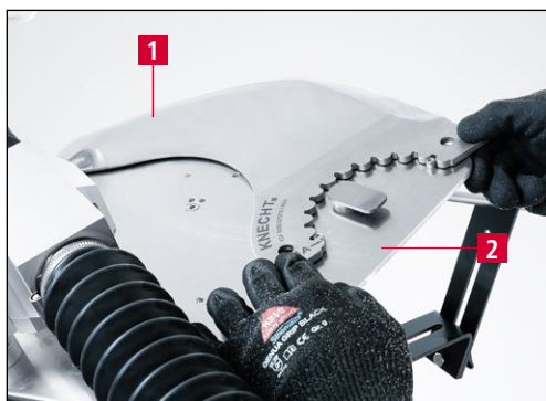
Slika 7-40 Pričvršćivanje noža na brusnu podlogu
