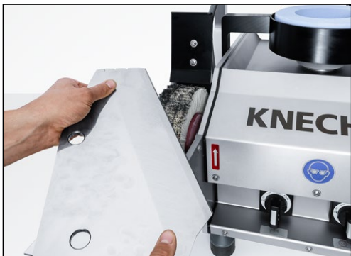
Slika 7-21 Uklanjanje srhova i poliranje linear-nih noževa na četkici s lamelama
