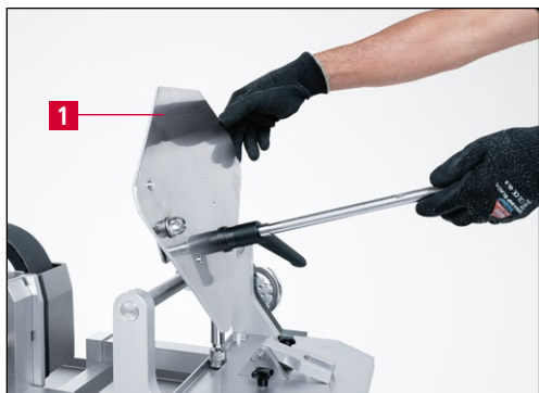
Slika 9-8 Zakretanje brusne podloge prema natrag
