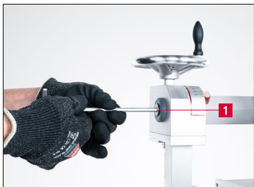
Slika 6-1 Uklanjanje zakretnog kraka
