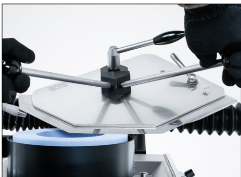
Slika 7-15 Poravnanje noža na brusnoj ploči
