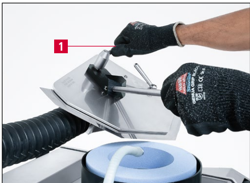
Slika 7-14 Otpuštanje poluge za pričvršćivanje
