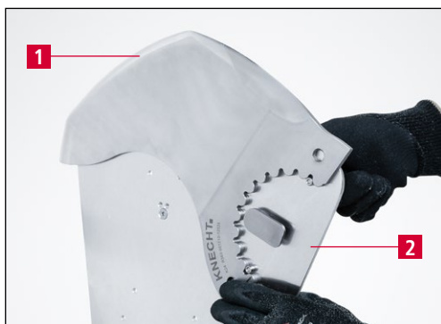
Slika 9-36 Pričvršćivanje noža na brusnu podlogu
