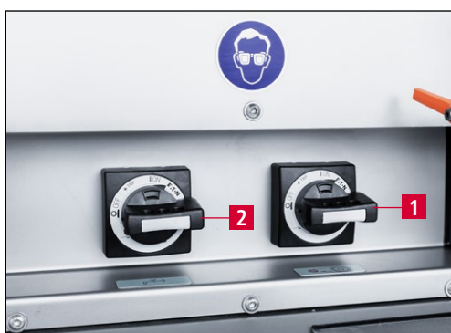
Slika 7-46 Uključivanje brusilice i uređaja za rashladno sredstvo
