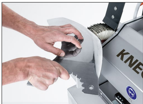
Slika 9-50 Uklanjanje srhova i poliranje skalpela na četkici s lamelama
