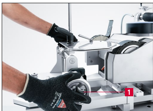
Slika 9-15 Pomicanje brusnog uređaja do brusne trake
