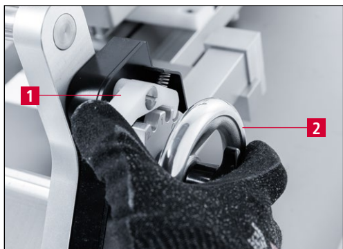
Slika 9-13 Dovođenje brusnog uređaja u položaj namještanja „0“
