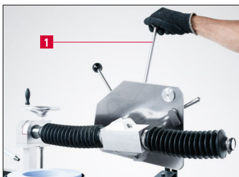
Slika 7-8 Zakretanje brusne podloge prema natrag
