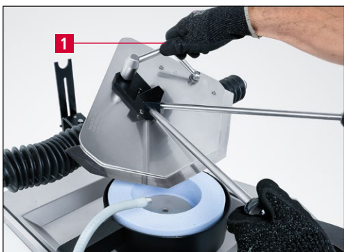
Slika 7-16 Pritezanje poluge za pričvršćivanje
