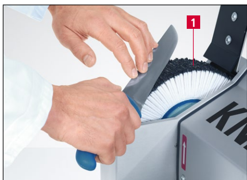
Slika 7-8 Uklanjanje srhova i poliranje ručnog noža
