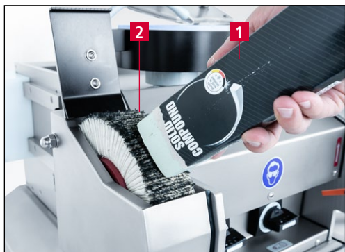
Slika 7-5 Nanošenje paste za poliranje
