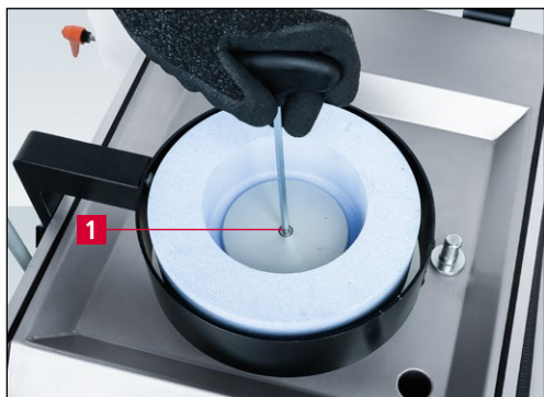
Slika 7-12 Zamjena brusne ploče
