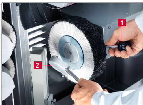
7-20. ábra A polírozóegység lamellás keféjének cseréje
