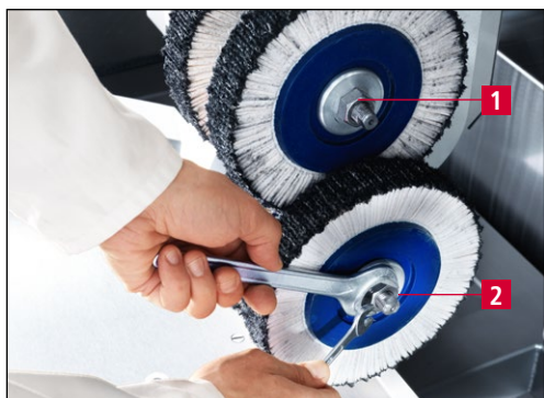
7-22. ábra A sorjázóegység lamellás keféjének cseréje
