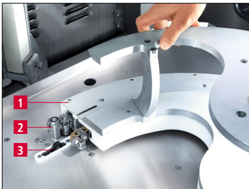
7-2. ábra A másolatcsiszoló lemez beszerelése
