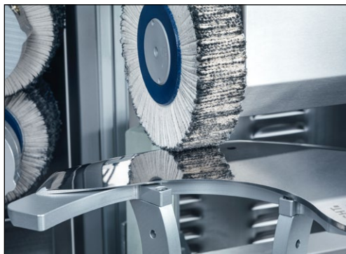
7-12. ábra A polírozóegység beállítása
