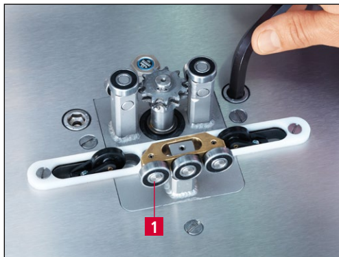
6-4. ábra A forgásirány ellenőrzése
