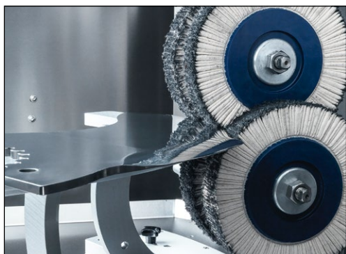
7-9. ábra A sorjázóegység beállítása
