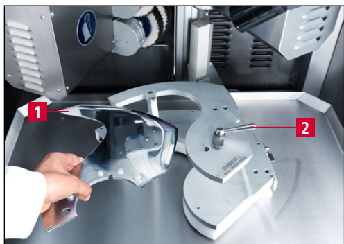
7-4. ábra A kés felhelyezése
