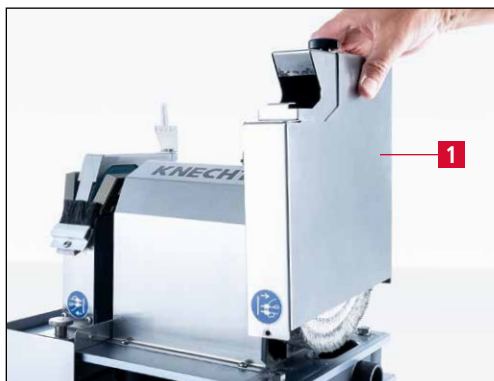
7-12. ábra A polírozótárcsa burkolatának levétele
