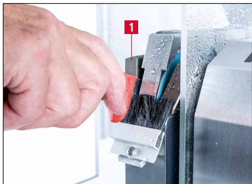
7-2. ábra A kézikés csiszolása
