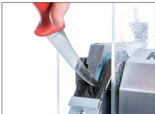
7-3. ábra A kézikés csiszolása
