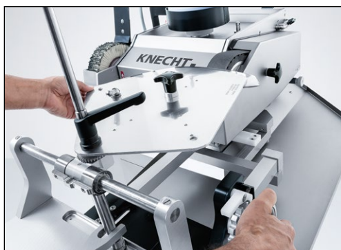
9-42. ábra A csiszolóberendezés mozgatása a csiszolószalaghoz
