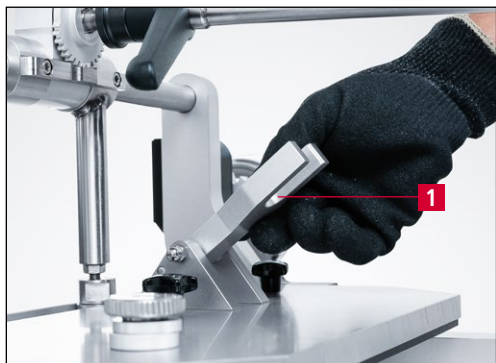
9-1. ábra A futókocsi kioldása
