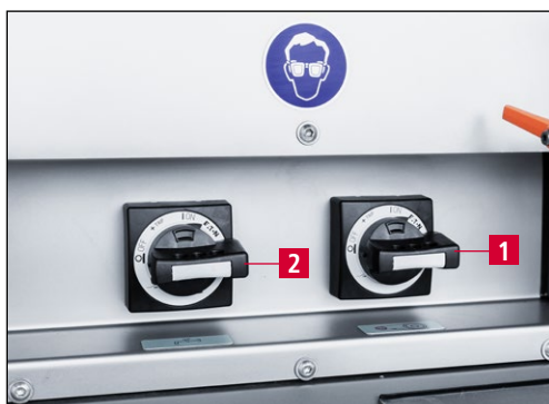
9-19. ábra A csiszológép és a hűtőfolyadék-rendszer bekapcsolása
