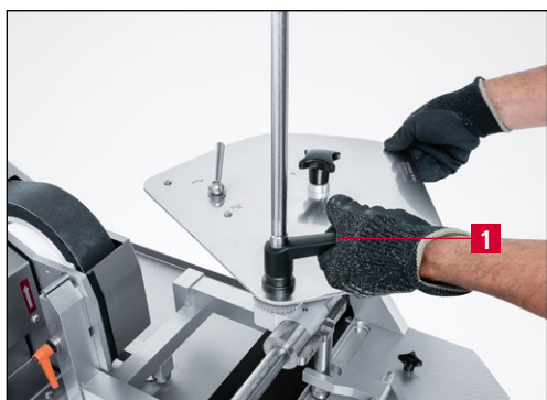
9-33. ábra A lengéstartomány beállítása
