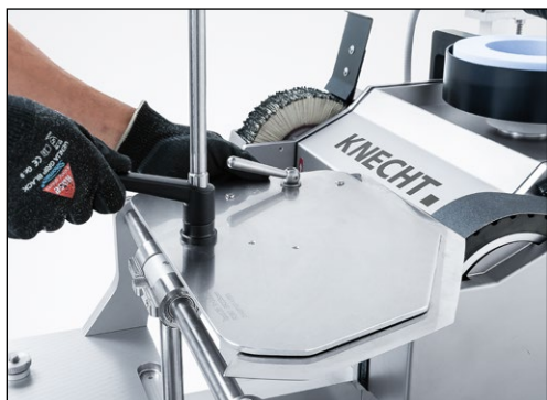
9-17. ábra A kés beállítása a csiszolószalagon
