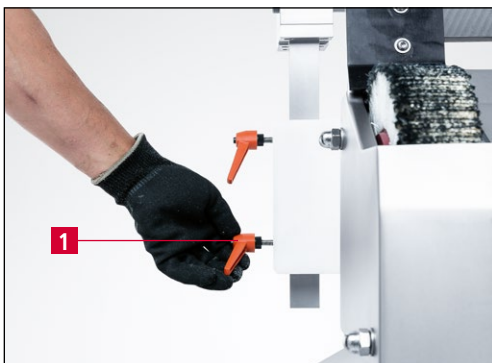
7-13. ábra A kés beállítása a csiszolótárcsa közepén
