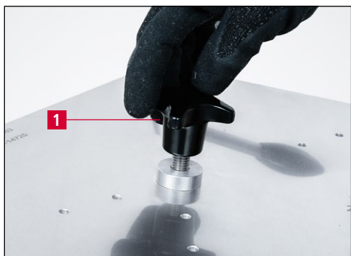
7-36. ábra A keresztfogantyú levétele
