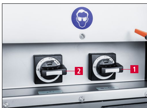
9-43. ábra A csiszológép és a hűtőfolyadék-rendszer bekapcsolása
