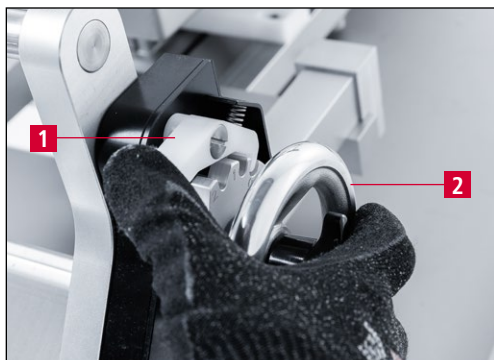
9-13. ábra A csiszolóberendezést állítsa „0”-ra
