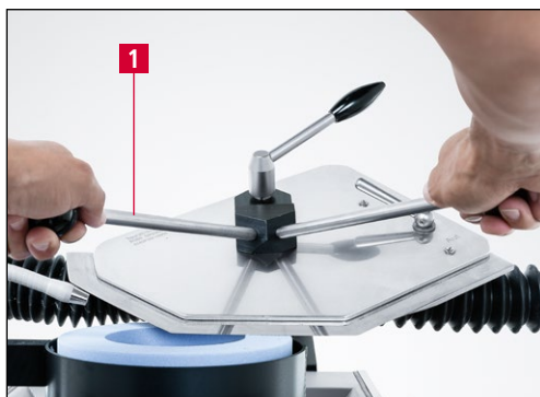
7-23. ábra Lineáris vágókések csiszolása
