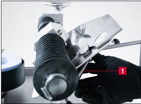
7-10. ábra A kés rögzítése a csiszolótárcsán
