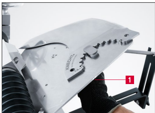
7-41. ábra A kés rögzítése a csiszolótárcsán
