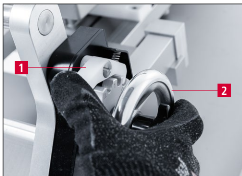
9-40. ábra A csiszolóberendezést állítsa „0”-ra
