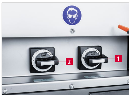
7-19. ábra A csiszológép és a hűtőfolyadék-rendszer bekapcsolása
