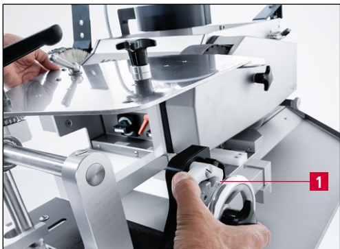
9-46. ábra Sarló formájú vágókés csiszolása domború módon
