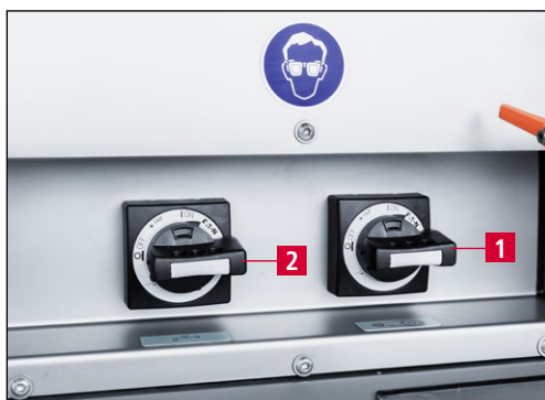
7-22. ábra A csiszológép és a hűtőfolyadék-rendszer bekapcsolása
