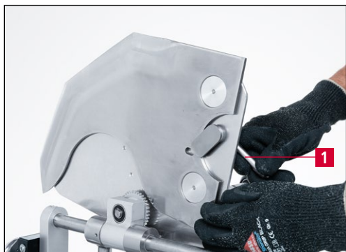
9-10. ábra A kés rögzítése a csiszolótárcsán
