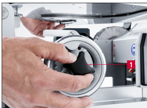
9-41. ábra A keresztfogantyú kioldása
