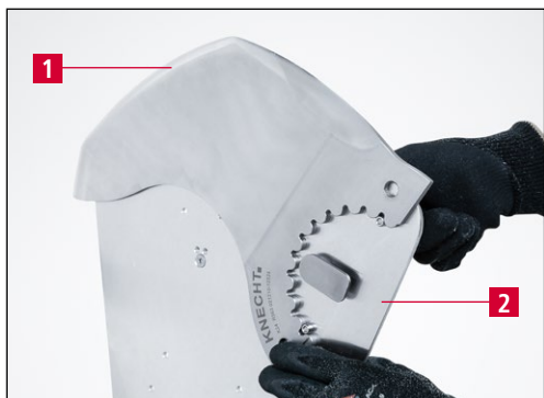
9-36. ábra A kés felfogatása a csiszolótárcsára
