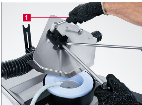
7-16. ábra A szorítókar meghúzása
