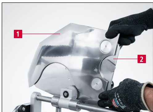
9-9. ábra A kés felfogatása a csiszolótárcsára
