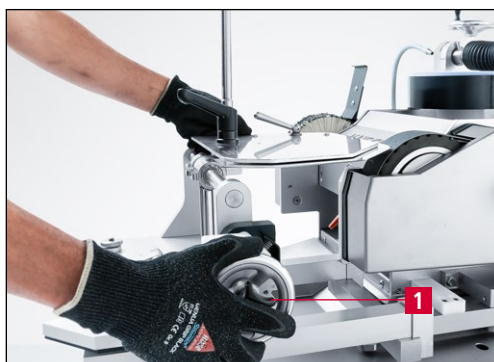
9-15. ábra A csiszolóberendezés mozgatása a csiszolószalaghoz
