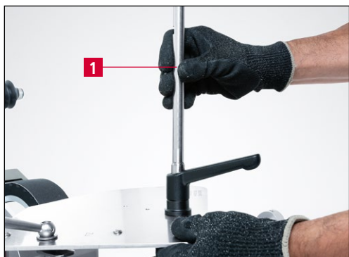
9-7. ábra A csiszolótárcsa megfeszítése
