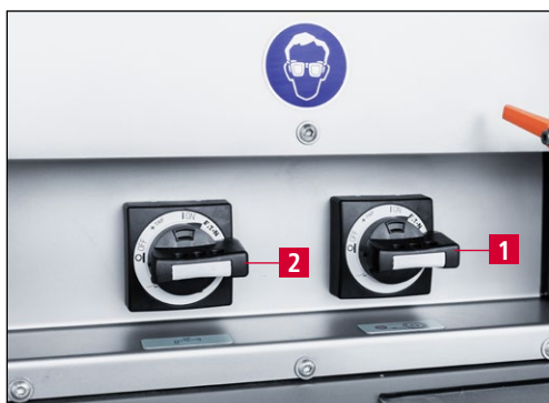
7-46. ábra A csiszológép és a hűtőfolyadék-rendszer bekapcsolása
