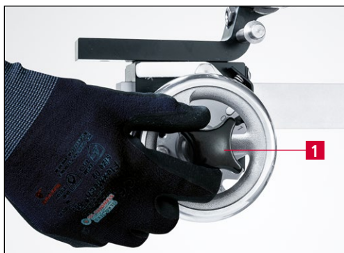
9-13. ábra A keresztfogantyú kioldása
