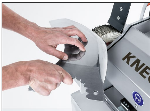
9-22. ábra Vágókés sorjázása és polírozása a lamellás kefén
