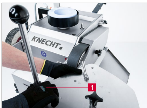
9-5. ábra A lengéstartomány beállítása
