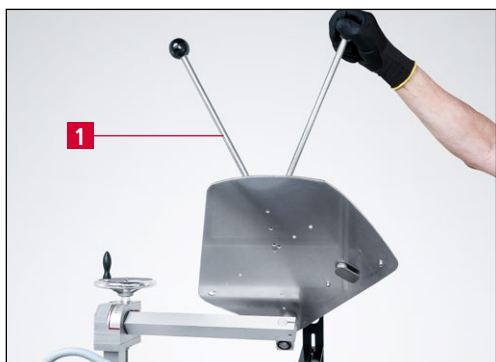
7-10. ábra A csiszolótárcsa hátrafordítása
