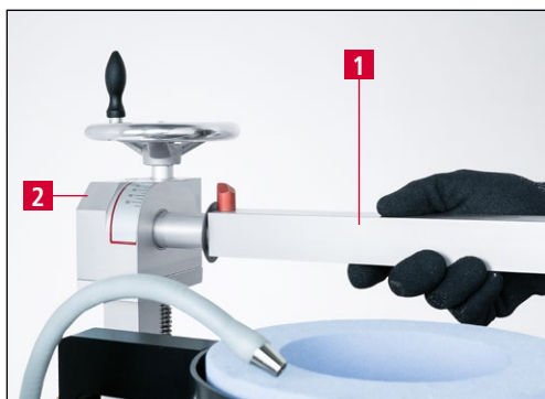
6-2. ábra A HV 207 lengőkar felszerelése
