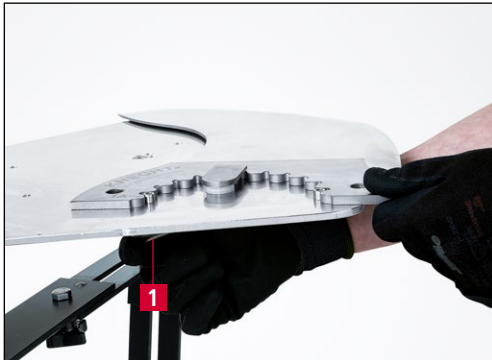
7-12. ábra A kés rögzítése a csiszolótárcsán
