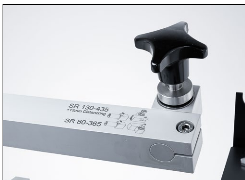
7-1. ábra A rögzítőfej helyzetének ellenőrzése
