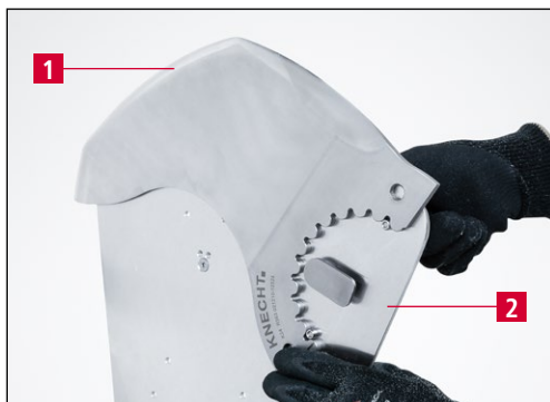
9-8. ábra A kés felfogatása a csiszolótárcsára
