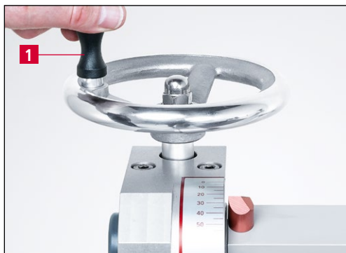
7-19. ábra A csiszolási szög csökkentése (domború csiszolás)
