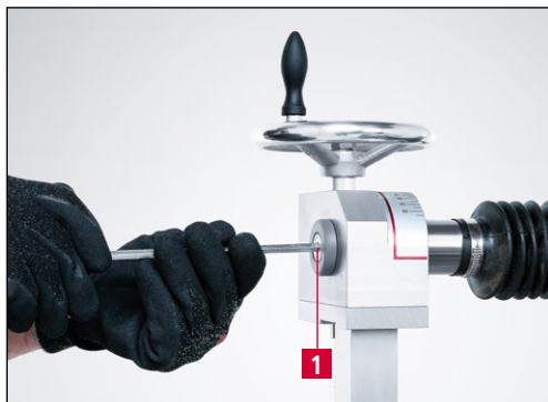
6-1. ábra A HV 203 univerzális csiszolókar levétele
