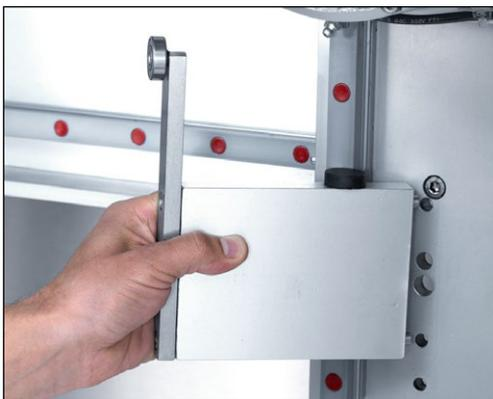
Figura 7-4 Montaggio dell'accoppiamento Z
