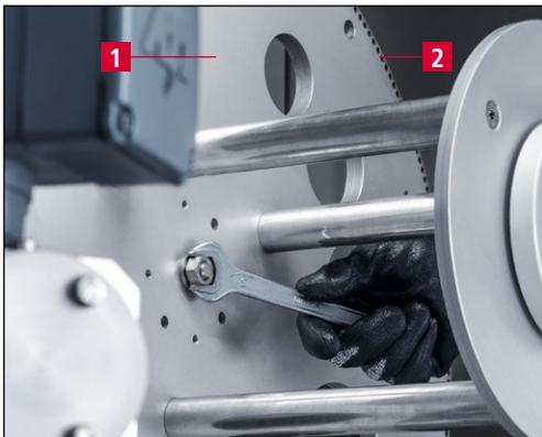
**Figura 7-5** Montaggio della camma a disco SP 116
