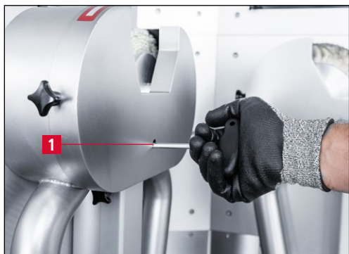
図 7-16 研磨リング/バリ取りリングを回して分離する
