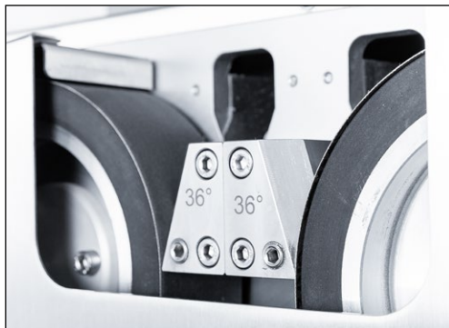
図 7-9 湿式研磨ベルトの調整
