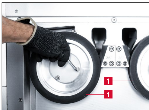
図 9-1 接触ディスクの取り外し
