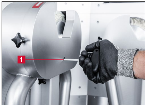
Figur 7-16 Vri fra hverandre polerings-/avgradingsringer
