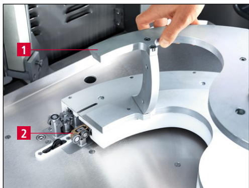
Rys. 7-16 Nasuwanie płyty kopiowej na wózek prowadzący
