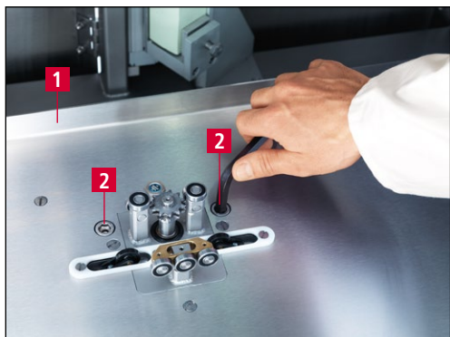
Rys. 9-7 Demontaż osłony blaszanej
