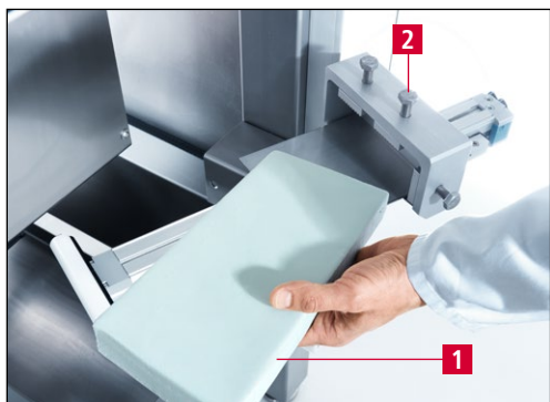
Rys. 7-24 Wymiana lewej pasty polerskiej
