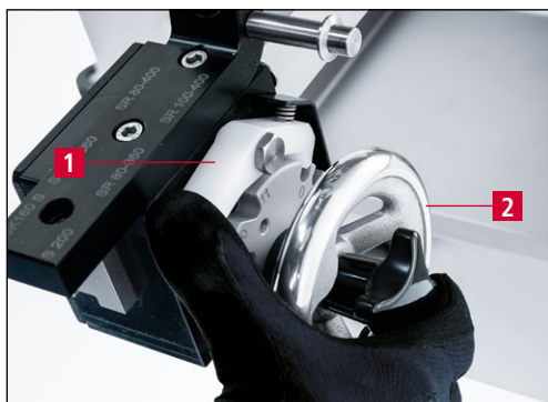
Rys. 9-12 Ustawianie urządzenia ostrzącego w pozycji „0”
