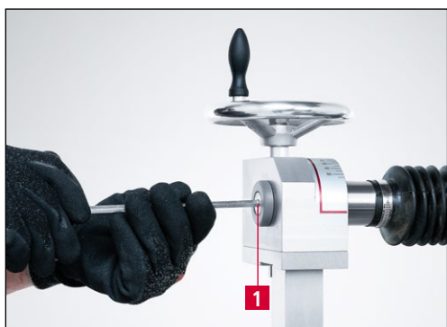
Rys. 6-1 Demontaż uniwersalnego ramienia szlifującego HV 203
