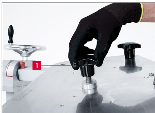
Rys. 7-6 Demontaż uchwytu krzyżowego
