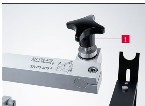
Rys. 3-3 Obrotowa głowica montażowa
