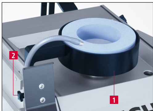
Rys. 7-11 Ustawianie osłony ściernicy
