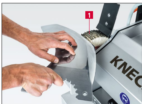
Rys. 7-6 Usuwanie zadziorów i polerowanie noży do kutrów
