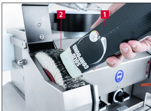
Rys. 7-5 Nakładanie pasty polerskiej
