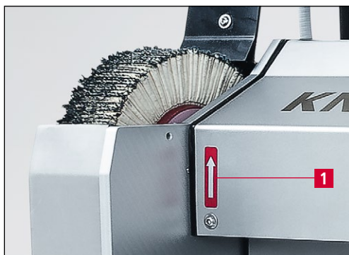
Rys. 6-2 Sprawdzanie kierunku obrotu
