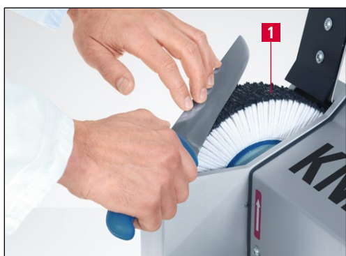
Rys. 7-8 Usuwanie zadziorów i polerowanie noża ręcznego
