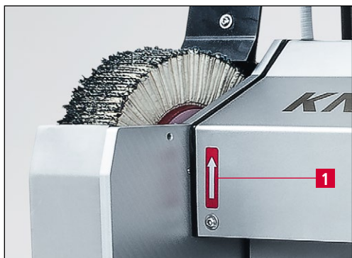
Rys. 6-2 Sprawdzanie kierunku obrotu
