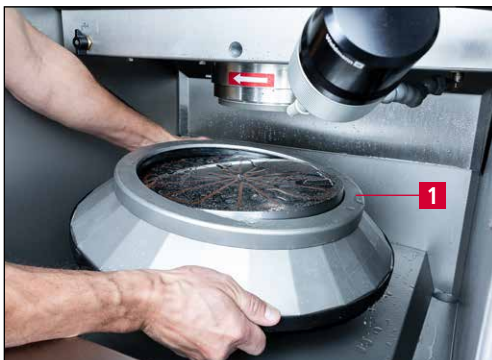
Rys. 8-3 Zdejmowanie pierścienia ociekowego
