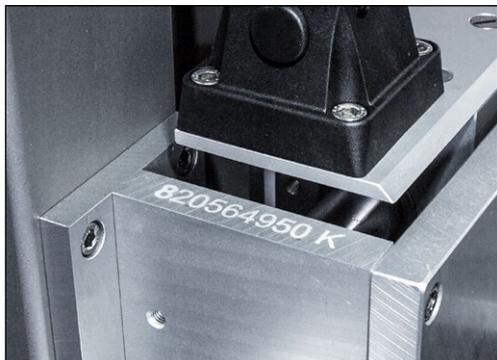
O número da máquina (1-2) encontra-se na placa de identificação (1-1) e na parte frontal esquerda da máquina.
