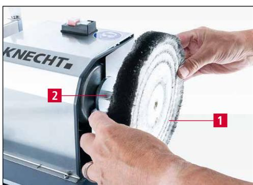
**Imagem 7-14** Substituir o disco de polimento
