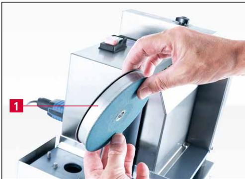
**Imagem 7-9** Montar o novo par de discos de afiação
