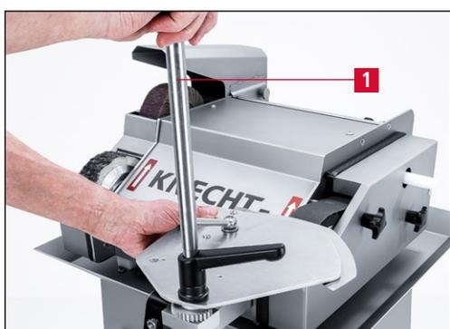
Рис. 7-21 Поворот куттерного ножа на следующий сегмент режущей кромки
