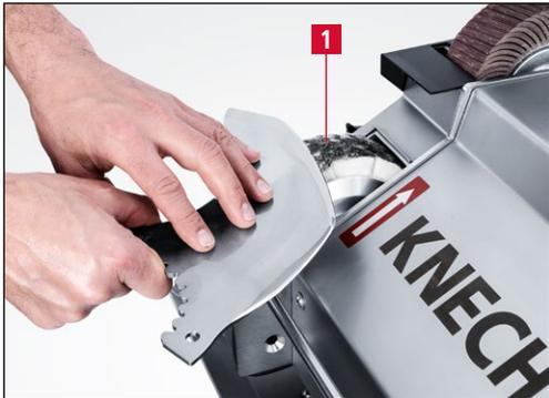
**Рис. 7-22** Снятие заусенцев и полирование куттерных ножей на пластинчатой щетке
