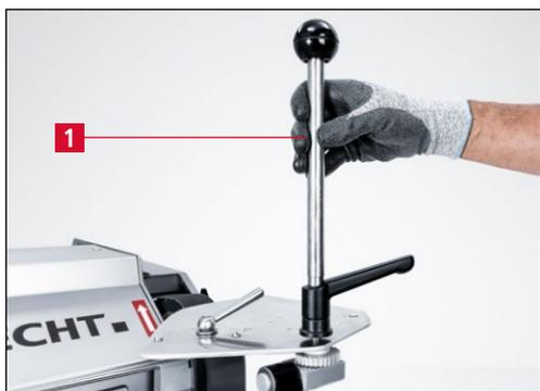
Рис. 7-4 Легкое затягивание рычага для заточки
