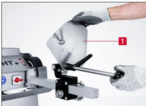
Рис. 7-6 Поворот шлифовальной пластины назад в стопор от проворачивания
