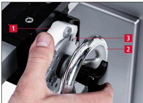
**Рис. 7-16** Установка приспособления для заточки в положение заточки «1»
