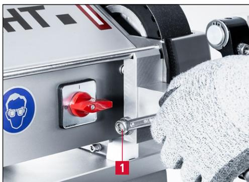
Рис. 6-2 Фиксация устройства для ленточной заточки
