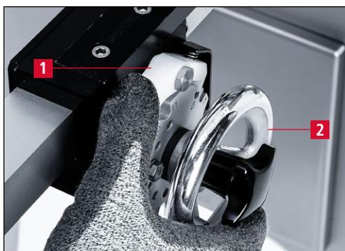
Рис. 7-12 Установка приспособления для заточки в положение регулировки «0»
