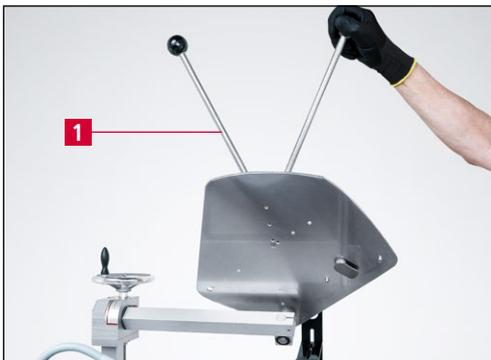
Рис. 7-10 Поворот шлифовальной пластины назад
