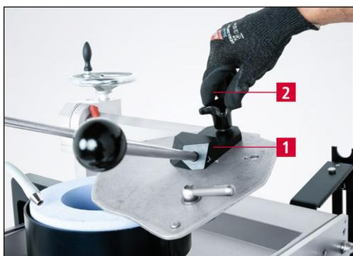
**Рис. 7-9** Монтаж рычага для заточки на крепежном болте
