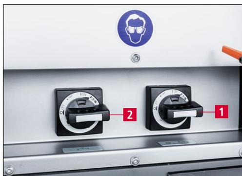
Рис. 9-15 Включение станка для заточки и системы охлаждения
