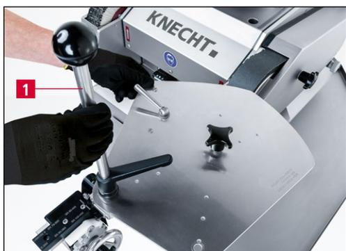
Рис. 9-4 Легкое затягивание рычага для заточки
