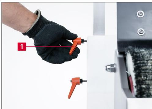
Рис. 7-15 Ослабление зажимного рычага
