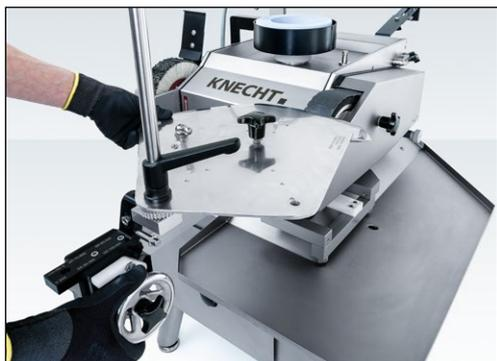
**Рис. 9-14** Перемещение приспособления для заточки к шлифовальной ленте
