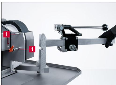
Рис. 8-2 Поворот устройства HV 261 в рабочее положение
