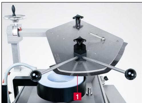
**Рис. 7-13** Положение ножа на шлифовальном круге
