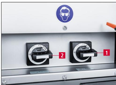
Рис. 7-17 Включение станка для заточки и системы охлаждения
