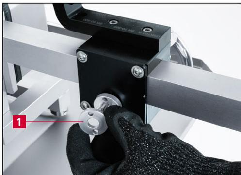
Рис. 9-1 Регулировочные шайбы для настройки угла заточки
