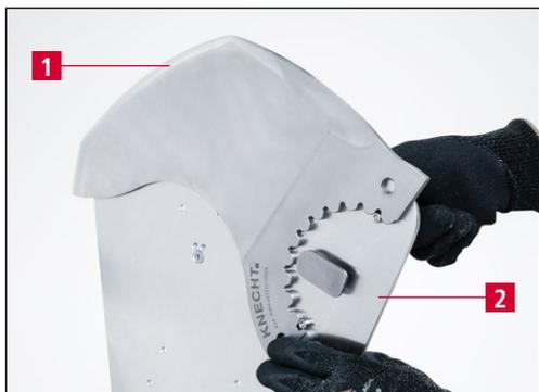
Рис. 9-8 Крепление ножа на шлифовальной пластине
