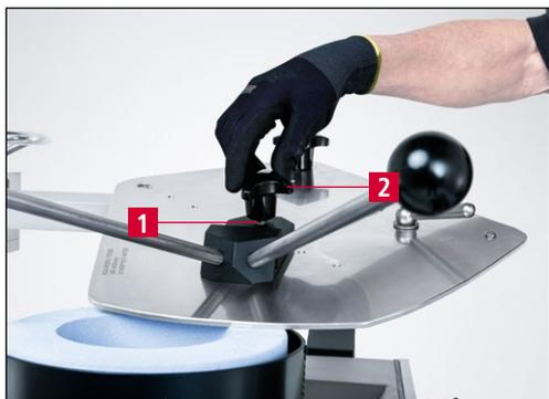
**Рис. 7-8** Монтаж рычага для заточки на шлифовальной пластине
