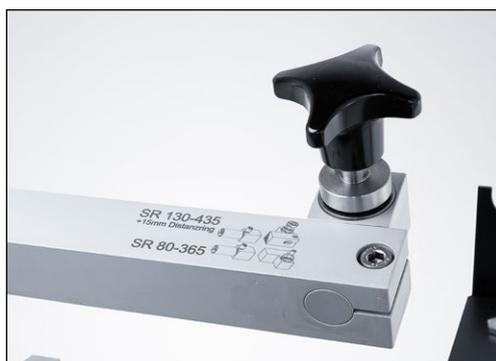
Рис. 7-1 Проверка положения зажимной головки
