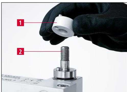
Рис. 7-3 Установка регулировочной шайбы на болт крепления
