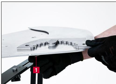
**Рис. 7-12** Фиксация ножа на шлифовальной пластине
