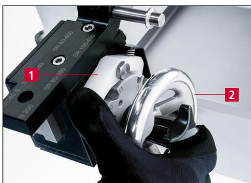
Для приведения устройства для ленточной заточки в положение регулировки нажать большим пальцем стопорный рычаг (9-12/1), а остальными четырьмя пальцами повернуть маховик (9-12/2) до положения «0».
