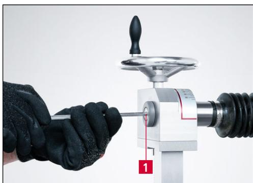
Рис. 6-1 Снятие универсального шлифовального рукава HV 203
