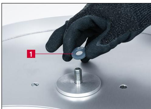
**Рис. 7-15** Установка центрирующей шайбы на болт крепления
