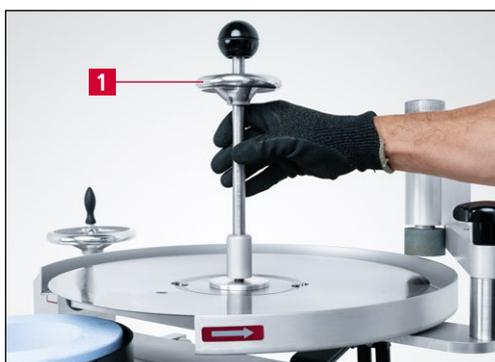
Рис. 7-17 Крепление дискового ножа
