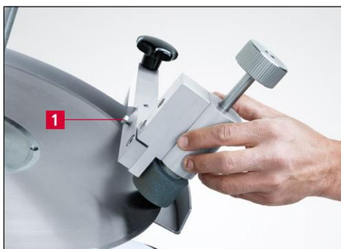
Рис. 7-25 Поворот кронштейна для снятия заусенцев
