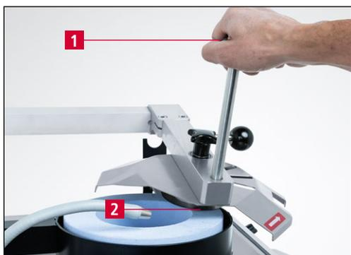
Рис. 7-11 Заточка дискового ножа
