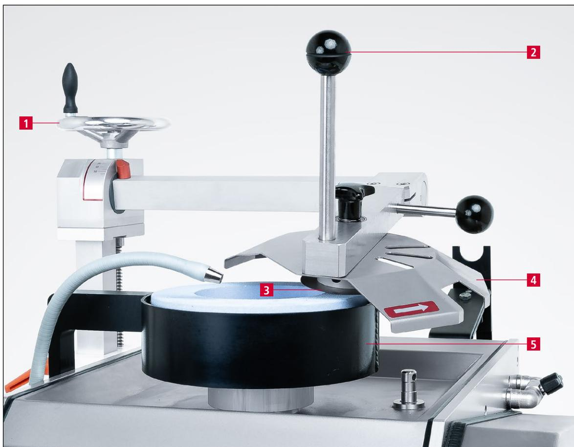
Рис. 3-3 Приспособление для заточки дисковых ножей HV 205-1
