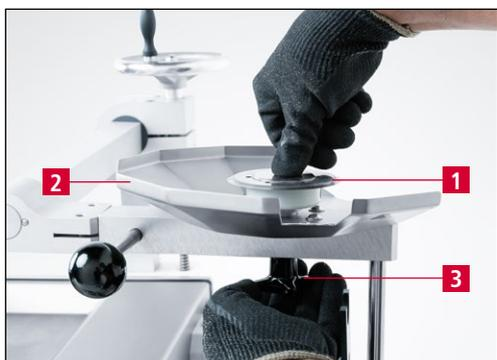
Рис. 7-3 Крепление дискового ножа
