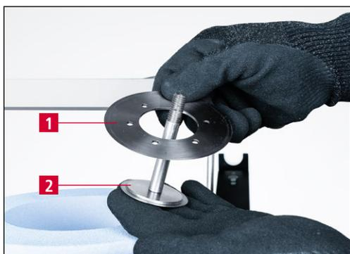
Рис. 7-2 Разместить дисковый нож на подходящем креплении ножа
