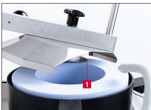
Рис. 7-5 Размещение дисковых ножей на шлифовальном круге
