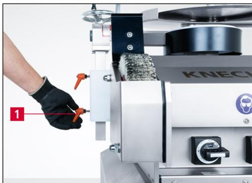
Рис. 7-19 Настройка приспособления для заточки дисковых ножей
