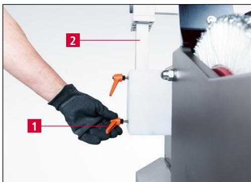
Рис. 7-6 Настройка приспособления для заточки дисковых ножей
