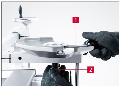
Рис. 7-4 Фиксация дискового ножа
