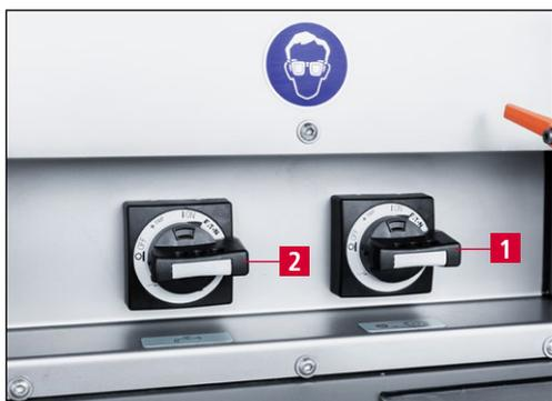
Рис. 7-22 Включение шлифовального станка и системы охлаждения
