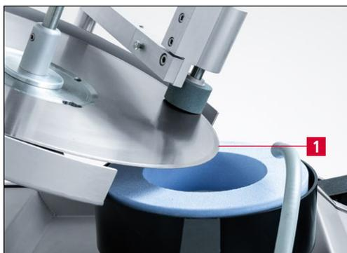
Рис. 7-18 Размещение дисковых ножей на шлифовальном круге
