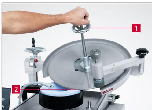
Рис. 7-23 Заточка дискового ножа
