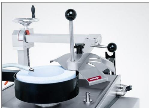
Рис. 7-1 Приспособление для заточки дисковых ножей HV 205-1
