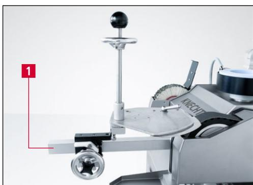
Рис. 7-2 Устройство для ленточной заточки HV 261
