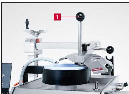
Рис. 7-18 Приспособление для заточки дисковых ножей HV 205-1
