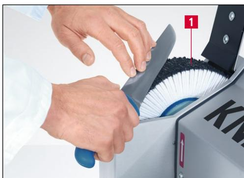
Рис. 7-8 Снятие заусенцев и полирование ручных ножей
