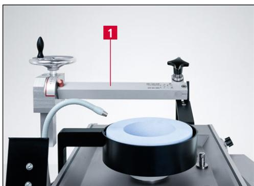
Рис. 7-1 Поворотный рукав HV 207
