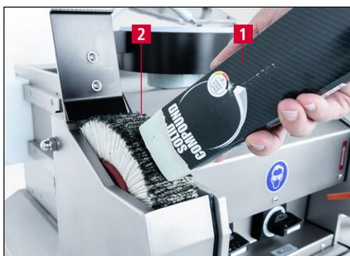
Рис. 7-5 Нанесение полировальной пасты
