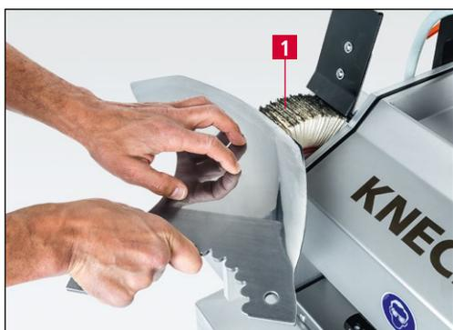
Рис. 7-6 Снятие заусенцев и полирование куттерного ножа
