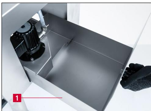
Рис. 6-1 Заполнение резервуара для воды
