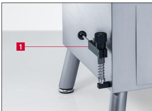
Рис. 7-9 Приспособление для правки HV 201
