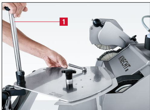
Рис. 7-68 Поворот куттерного ножа на следующий сегмент режущей кромки и заточка
