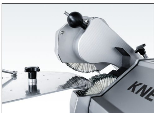
Рис. 7-58 Расстояние между пластинчатыми щетками прим. 20 мм
