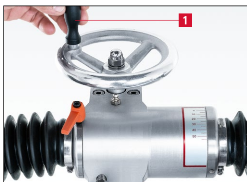
Рис. 7-91 Уменьшение угла заточки (выпуклая заточка)
