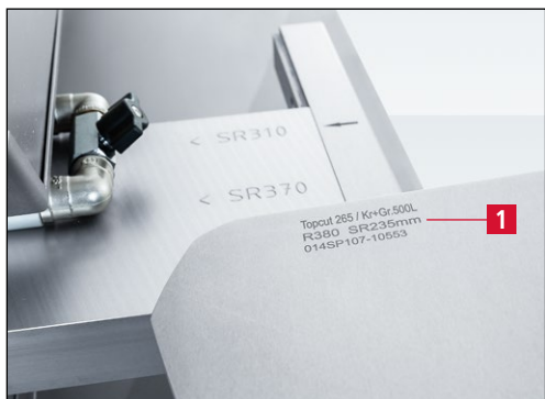
Рис. 7-95 Отображаемый радиус заточки на шлифовальной пластине SP 107
