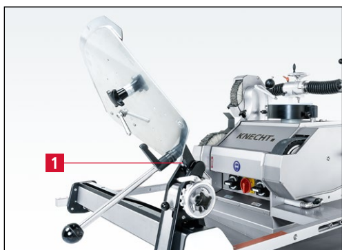
Рис. 7-63 Нож вне зоны полирования в безопасном положении
