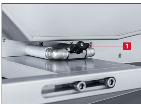
Рис. 3-5 Форсунка для дозирования охлаждающего средства на ленту для влажного шлифования
