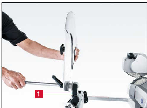
Рис. 7-52 Куттерный нож откинут назад и зафиксирован
