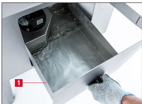
Рис. 6-1 Заполнение резервуара для воды
