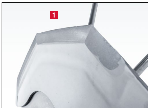
Рис. 7-93 Куттерный нож с предварительной выпуклой заточкой
