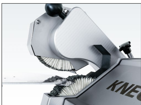
Рис. 7-125 Расстояние между пластинчатыми щетками прим. 20 мм
