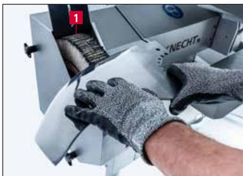
Рис. 7-14 Полирование и снятие заусенцев с куттерного ножа
