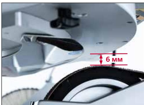
**Рис. 6-4** Расстояние от копировально-шлифовальной плиты до ленты для влажного шлифования
