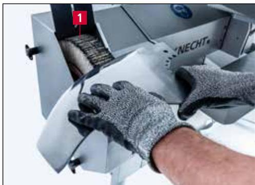
**Рис. 7-10** Полирование и снятие заусенцев с куттерного ножа
