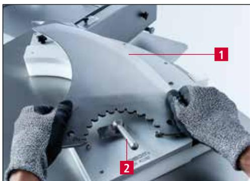
Рис. 7-4 Крепление куттерного ножа
