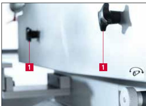
Рис. 7-17 Открывание защитного кожуха ленты
