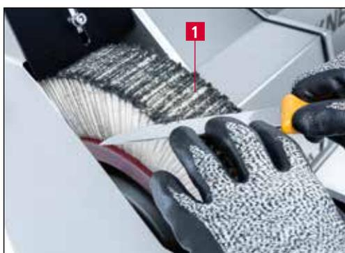
Рис. 7-16 Полирование ручного ножа
