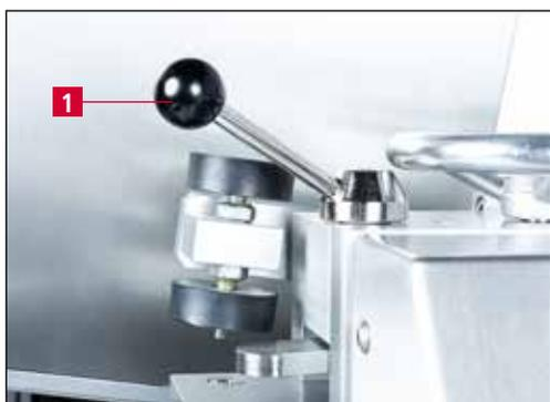
**Рис. 7-1** Перевод копировально-шлифовального устройства в положение замены
