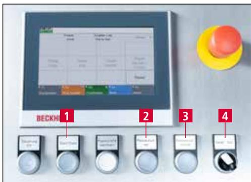
**Рис. 7-11** Прерывание процесса шлифования
