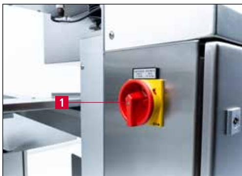
Рис. 3-7 Главный выключатель копировально-шлифовального устройства
