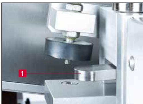
Рис. 7-5 Перевод копировально-шлифовального устройства в рабочее положение
