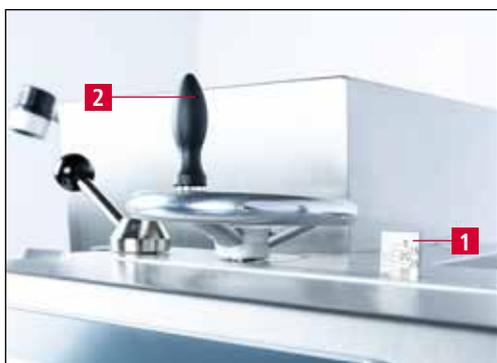
Рис. 7-7 Настройка угла заточки
