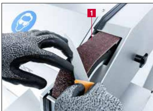
Рис. 7-15 Шлифование ручного ножа
