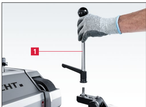
Slika 7-99 Odstranjevanje brusilne ročice
