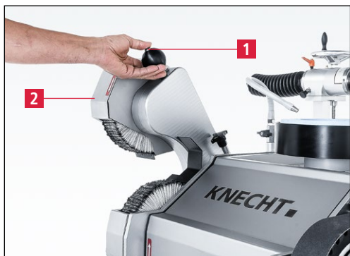
Slika 7-137 Zgornji polirni agregat v položaju mirovanja
