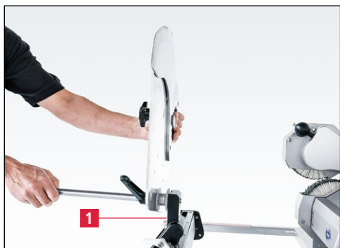
Slika 7-52 Nož za mesoreznice, poklopljen nazaj in zavarovan
