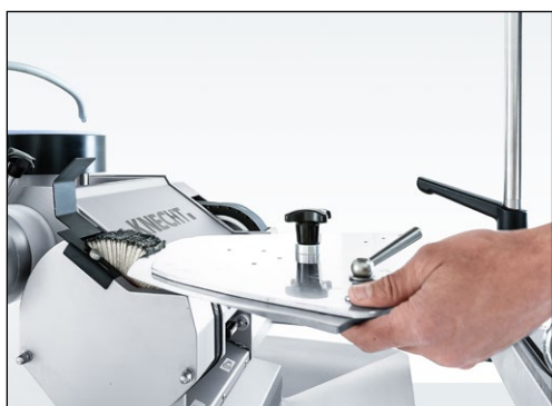
Slika 7-62 Poliranje obodov nožev
