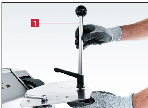
Slika 7-104 Vpenjanje brusilne plošče
