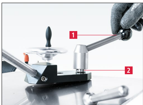
Slika 7-77 Pritrditev brusilne plošče
