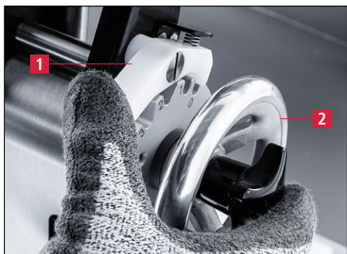
Slika 7-110 Namestitev brusilne naprave v nastavitveni položaj »0«
