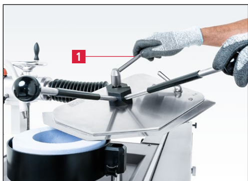
Slika 7-84 Sprostitev vpenjalnega vzvoda
