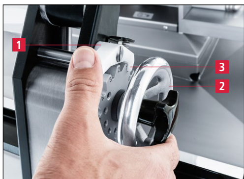
Slika 7-117 Namestitev brusilne naprave v položaj za brušenje »1«
