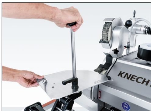
Slika 7-129 Poliranje obodov noža
