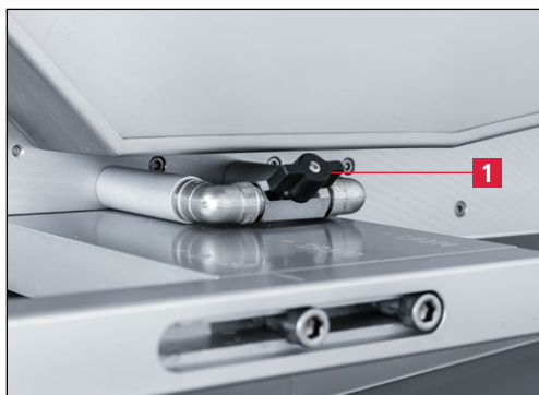
Slika 3-5 Enota za odmerjanje hladilne tekočine za mokri brusni trak
