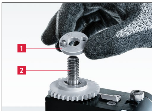
Slika 7-36 Nastavitev kota brušenja
