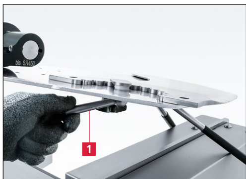
Slika 7-18 Blokiranje nožev na brusilni plošči
