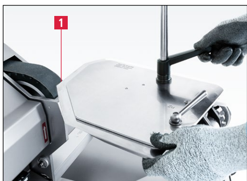
Slika 7-114 Poravnava noža z brusnim trakom
