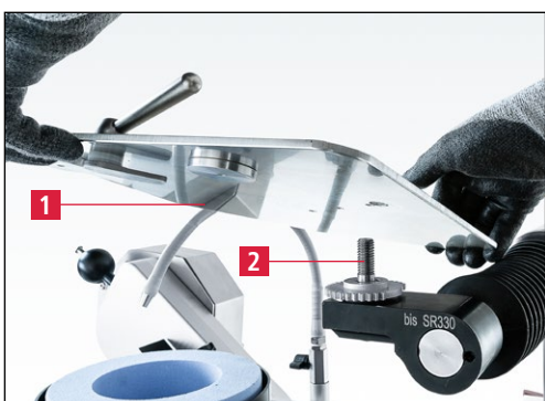
Slika 7-75 Vgradnja brusilne plošče
