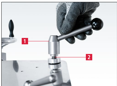
Slika 7-12 Pritrditev brusilne plošče
