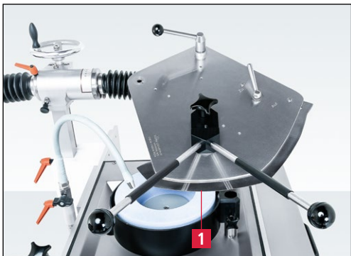
Slika 7-19 Položaj noža na brusilni plošči
