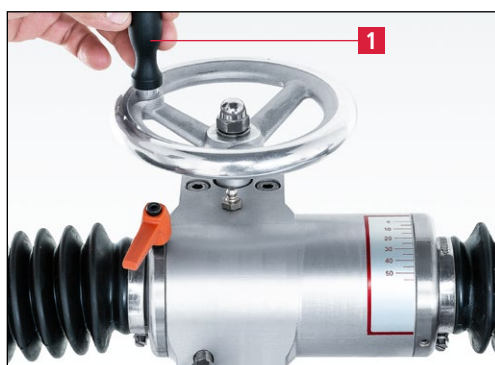
Slika 7-91 Zmanjšanje kota brušenja (konveksno brušenje)
