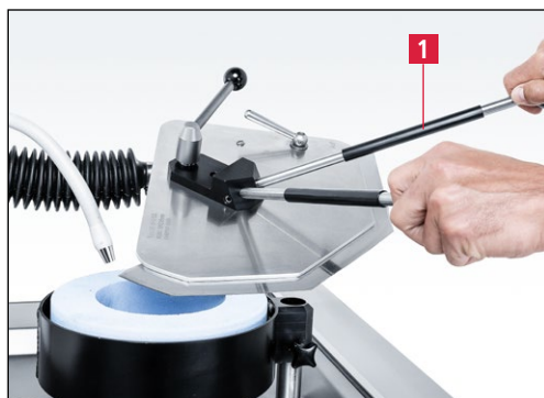
Slika 7-90 Brušenje linearnega noža za mesoreznice
