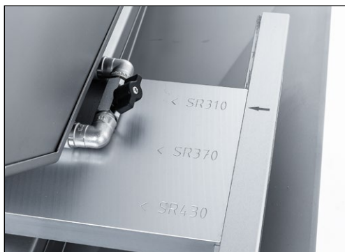
Slika 7-94 Nastavljen položaj brusilne in polirne naprave
