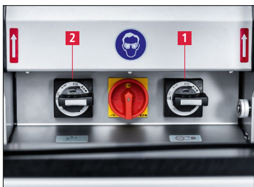
Slika 7-116 Vključitev brusilnega motorja in naprave za hladilno tekočino
