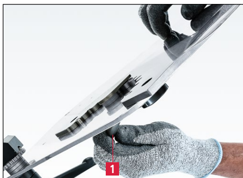
Slika 7-42 Blokiranje nožev na brusilni plošči
