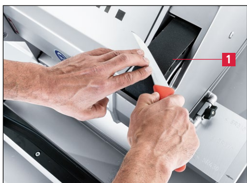
Slika 7-136 Brušenje ročnega noža
