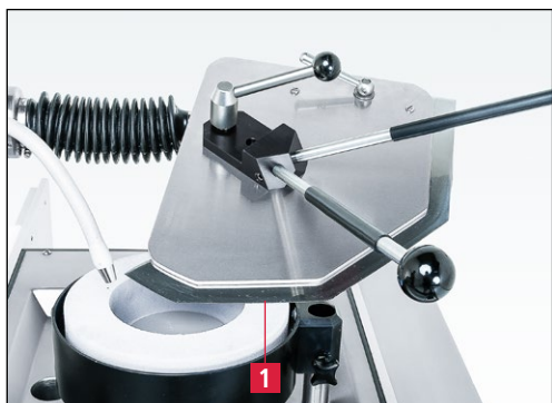
Slika 7-82 Položaj noža na brusilni plošči
