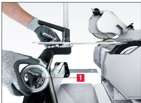
Slika 7-112 Premik brusilne naprave do brusnega traku
