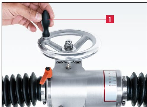
Slika 7-25 Zmanjšanje kota brušenja (konveksno brušenje)
