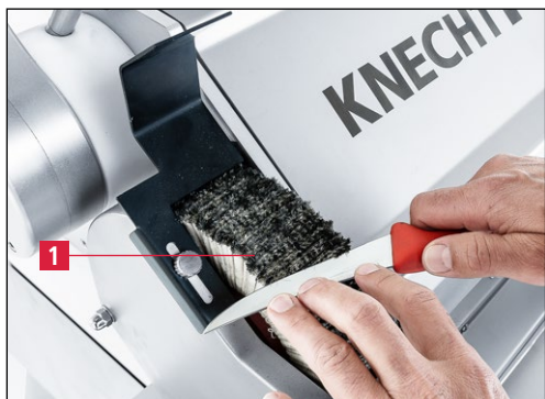
Slika 7-138 Posnemanje zarobkov in poliranje ročnega noža
