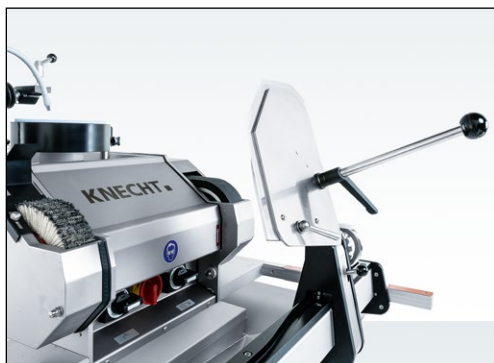
Slika 7-130 Nož zunaj območja poliranja v zavarovanem položaju
