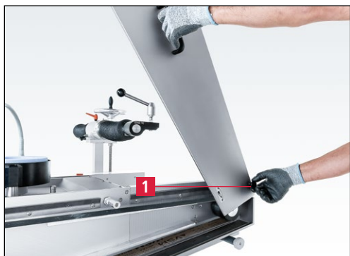
Slika 7-149 Zapiranje zaščitnega pokrova traku
