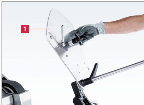
Slika 7-40 Brusilna plošča, obrnjena nazaj v varovalo pred zasukom
