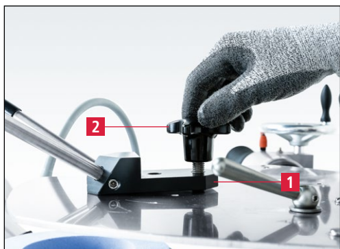
Slika 7-13 Vgradnja brusilne ročice na brusilno ploščo
