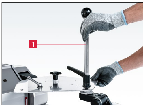
Slika 7-38 Rahlo privijanje brusilne ročice
