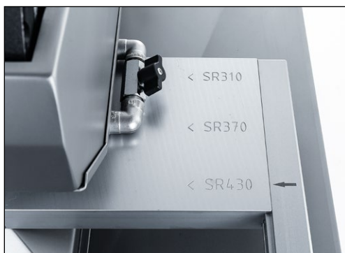
Slika 7-28 Nastavljen položaj brusilne in polirne naprave
