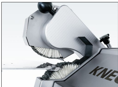
Slika 7-125 Razdalja med lamelnimi krtačami pribl. 20 mm
