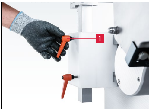
Slika 7-87 Sprostitev vpenjalne ročice
