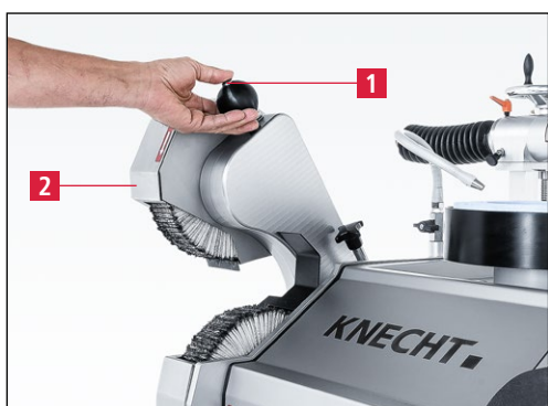
Slika 7-64 Namestitev zgornjega polirnega agregata v delovni položaj
