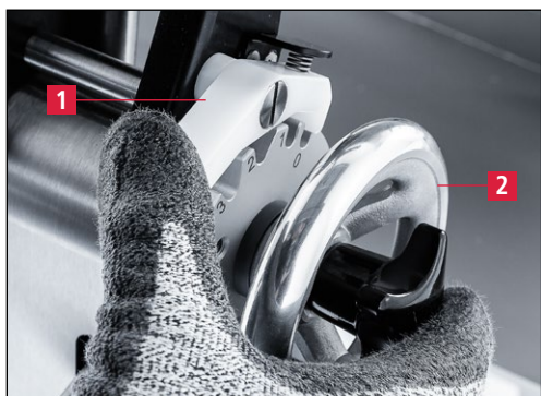
Slika 7-45 Nastavitev brusilne naprave v nastavitveni položaj »0«
