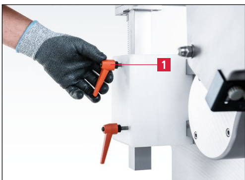
Slika 7-21 Sprostitev vpenjalne ročice
