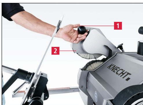
Slika 7-131 Namestitev zgornjega polirnega agregata v delovni položaj
