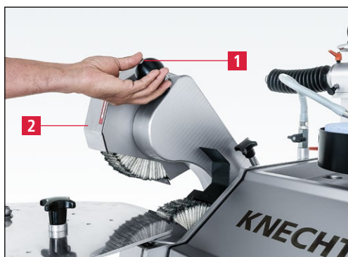
Slika 7-60 Obračanje zgornjega polirnega agregata navzgor
