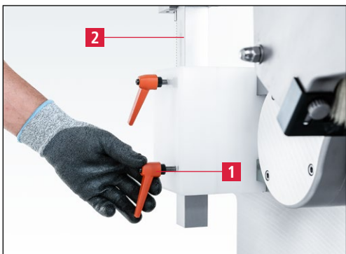
Slika 7-20 Nastavitev nožev na sredino brusilne plošče
