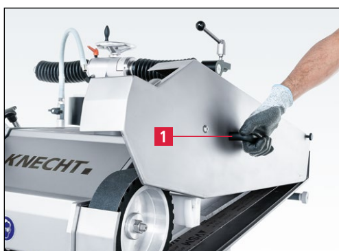
Slika 7-146 Odpiranje zaščitnega pokrova traku
