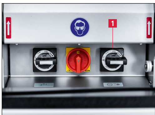
Slika 7-128 Vključitev brusilnega motorja
