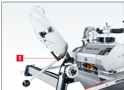
Slika 7-63 Rezilo zunaj območja poliranja v zavarovanem položaju
