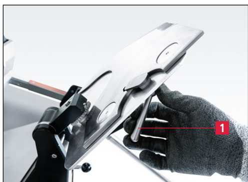
Slika 7-107 Blokiranje nožev na brusilni plošči
