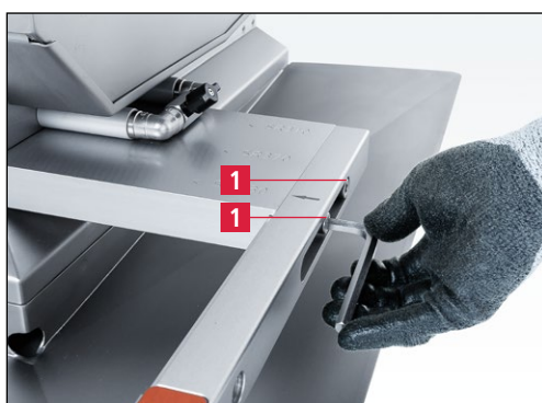
Slika 7-30 Odvijanje vijakov M 10
