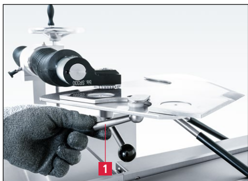
Slika 7-80 Blokiranje nožev na brusilni plošči
