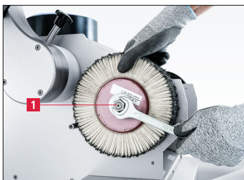
Slika 7-152 Zamenjava spodnje lamelne krtače
