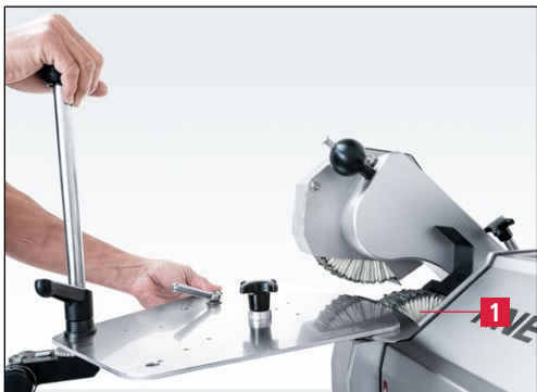
Slika 7-57 Nož leži na lamelni krtači
