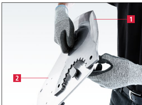
Slika 7-41 Vpenjanje noža na brusilno ploščo
