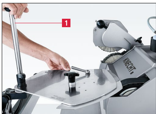
Slika 7-68 Obračanje in brušenje noža za mesoreznice na naslednji segment rezanja
