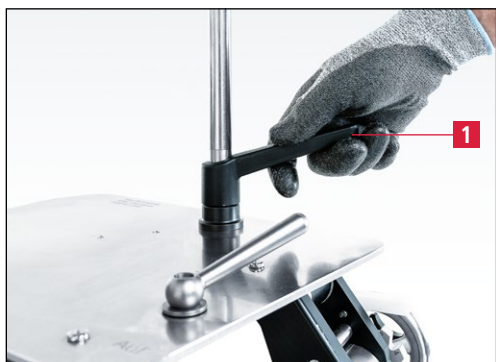
Slika 7-113 Sprostitev brusilne ročice
