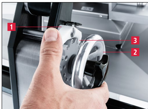
Slika 7-49 Nastavitev brusilne naprave v položaj za brušenje »1«
