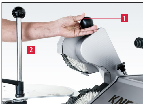
Slika 7-127 Obratovanje zgornjega polirnega agregata navzgor
