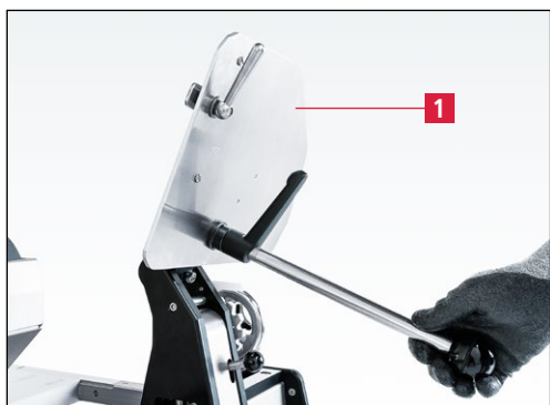
Slika 7-105 Obračanje brusilne plošče nazaj
