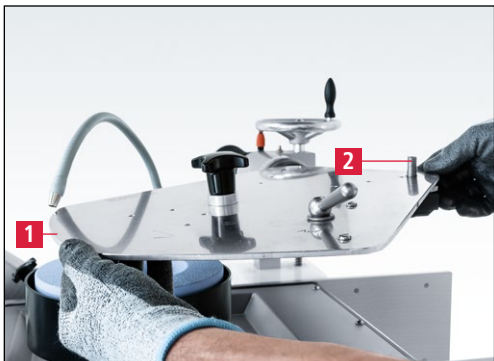
Slika 7-8 Vgradnja brusilne plošče
