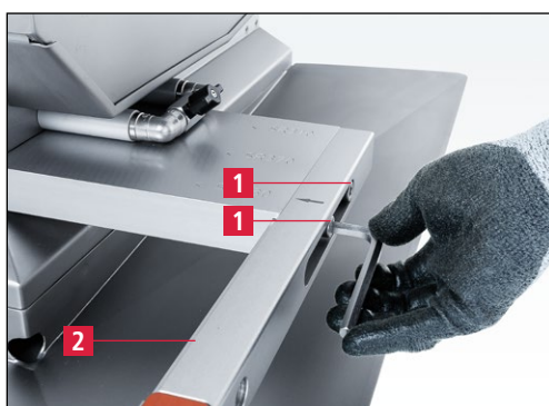
Slika 7-96 Odvijanje vijakov M 10
