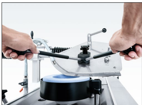
Slika 7-26 Obračanje noža za mesoreznico na naslednji segment rezanja
