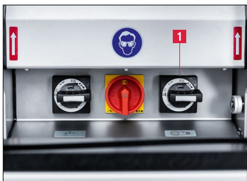
Slika 7-133 Izklop brusilnega motorja
