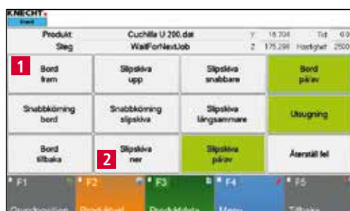
Bild 8-15 Kör bord och slipskiva till arbetsposition
