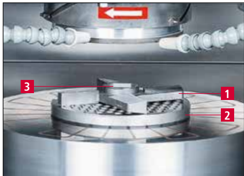
Bild 7-6 Slipning av stjärnknivar
