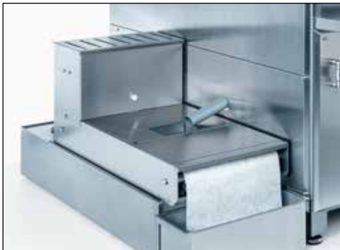
Bild 6-1 Fyll på kylmedelssystemet med bandfilter
