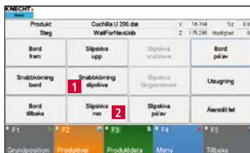
Bild 7-9 Skärpning av slipskivan
