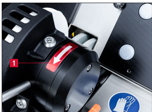
Obrázek 6-5 Kontrola směru otáčení
