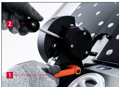
Obrázek 7-5 Otočení odjehlovací jednotky do horní koncové polohy
