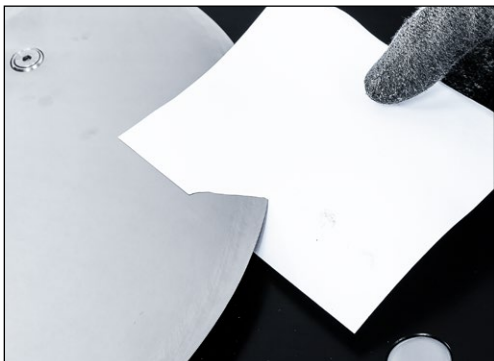
Obrázek 7-23 Kontrola ostrosti nože
