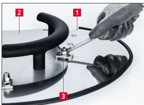
Obrázek 7-3 Upnutí srpovitého nože na kopírovací brusnou desku
