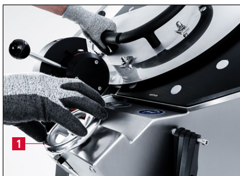
Obrázek 7-10 Přemístění brusné jednotky do dolní koncové polohy
