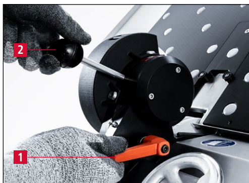
Obrázek 7-11 Otočení odjezlovací jednotky do horní koncové polohy
