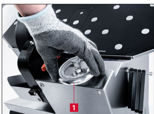
Obrázek 7-41 Přemístění brusné jednotky do horní koncové polohy
