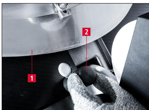
Obrázek 7-15 Odšroubování seřizovacího dorazu
