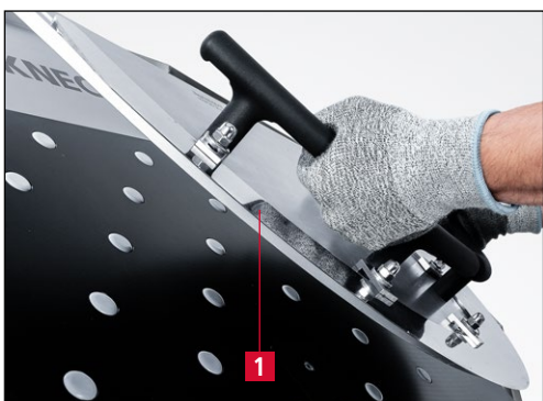
Obrázek 7-24 Odstranění kopírovací brusné desky s nožem
