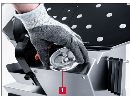
Obrázek 6-1 Přemístění brusné jednotky do horní koncové polohy
