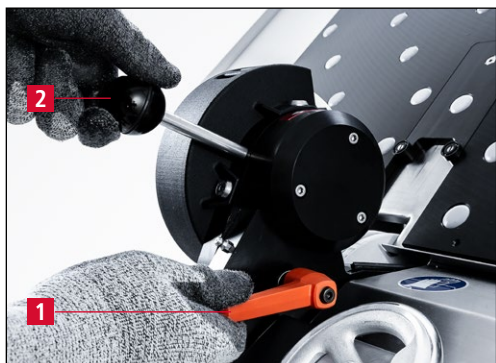
Obrázek 7-30 Přemístění odjehlovací jednotky do horní koncové polohy
