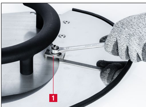
Figure 7-25 Serrage du couteau falciforme
