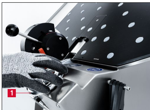
Figure 7-29 Déplacement du groupe d'affûtage en position médiane
