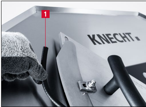
Figure 7-7 Retrait du protège-lame
