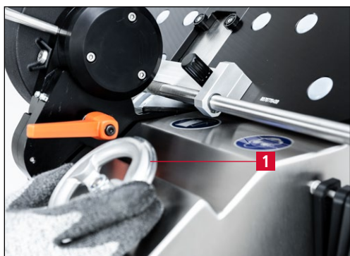
Figure 7-33 Déplacement du groupe d'affûtage en position de dressage
