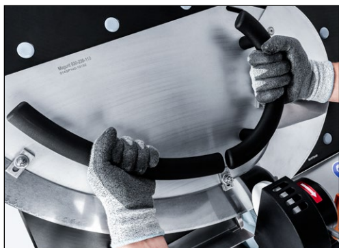
Figure 7-20 Position de départ de l'affûtage
