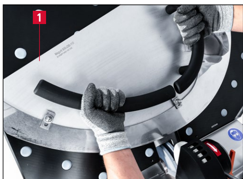
Figure 7-18 Déplacement du couteau falciforme vers le haut
