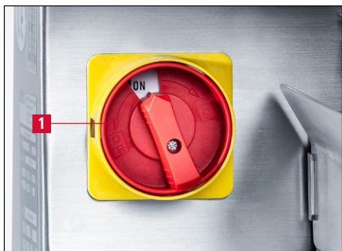
Figure 6-4 Activation de l'affûteuse
