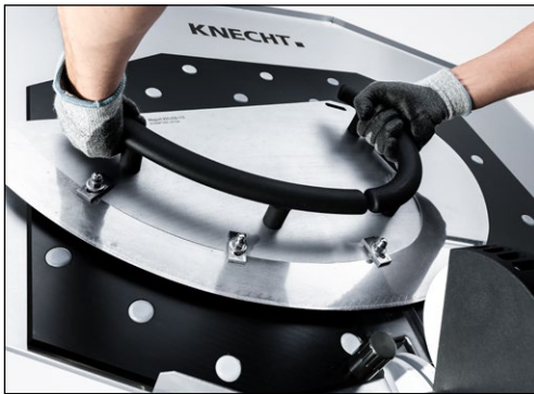
Figure 7-8 Positionnement du couteau falciforme
