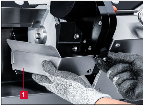
Figure 7-52 Mise en place de la coupelle d'eau
