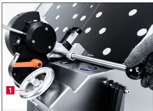
Figure 7-34 Dressage du disque d'affûtage
