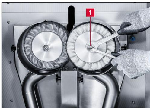
Figure 7-40 Dévisser l'écrou de serrage droit
