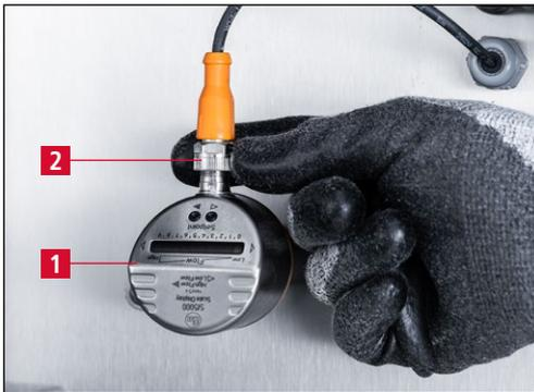
Figure 9-6 Débrancher le contrôleur de débit
