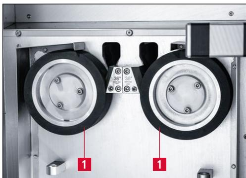
Figure 9-10 Démontez les disques de contact
