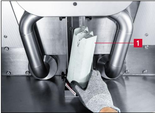
Figure 7-59 Remplacer la pâte de polissage
