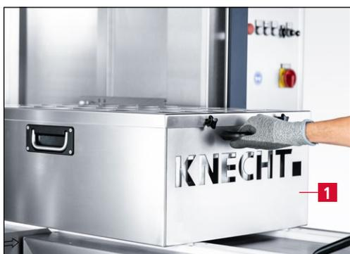
**Figure 9-14** Insérer le magasin à couteaux vide dans la machine
