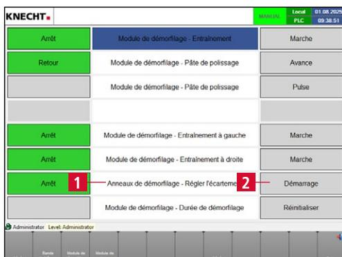
Figure 7-35 Régler les anneaux de démorfilage
