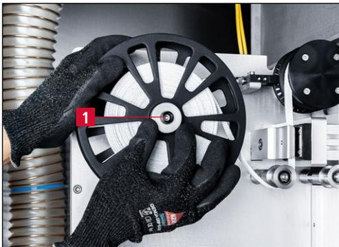
**Figure 7-61** Retirer le fil de test usagé
