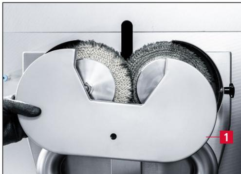
Figure 7-22 Retirer le capot de protection
