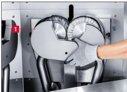
Figure 7-39 Retirer le capot de protection
