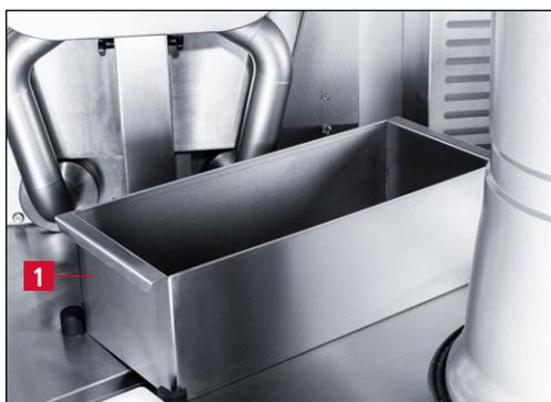
Figure 7-56 Retirer le réservoir
