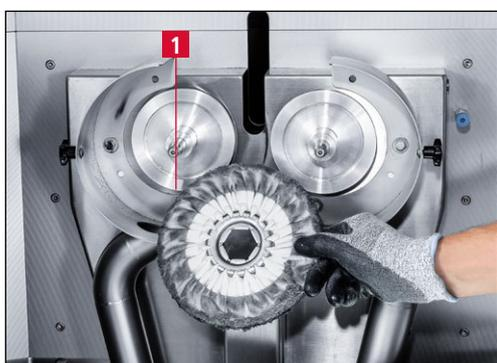
Figure 7-49 Remplacer les anneaux de polissage
