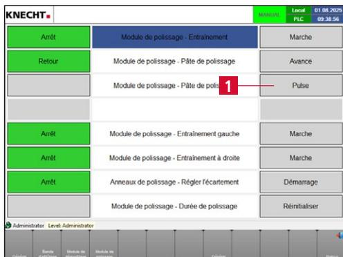
Figure 7-51 Appliquer la pâte de polissage
