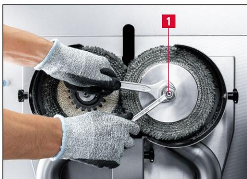
**Figure 7-27** Dévisser l'écrou de serrage droit
