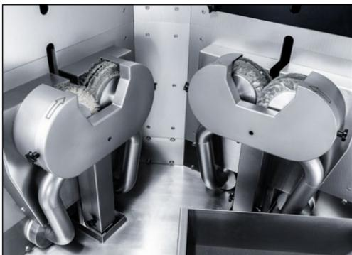
Figure 3-4 Modules de démorfilage et de polissage
