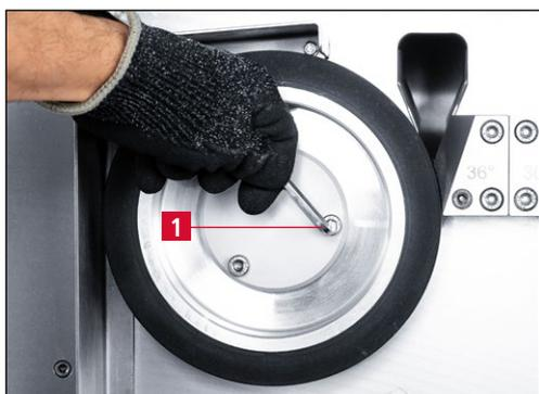
Figure 9-11 Démontez les disques de contact
