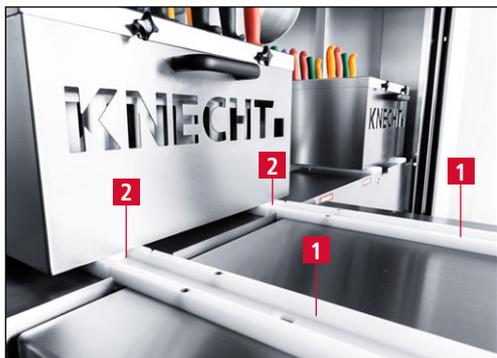
Figure 5-1 Réglage la hauteur du chariot à magasins
