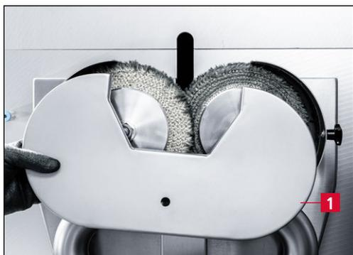
Figure 7-22 Retirer le capot de protection
