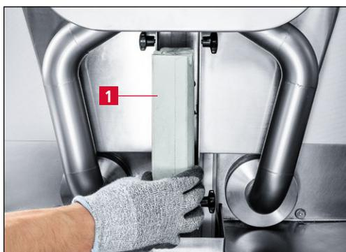
Figure 7-55 Remplacer la pâte de polissage
