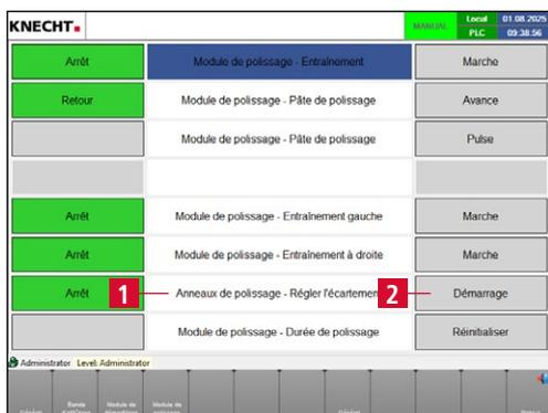
Figure 7-52 Régler les anneaux de polissage
