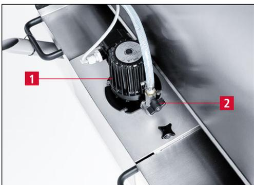
Figure 3-6 Pompe à liquide de refroidissement
