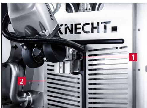
Figure 7-7 Retirer le capot de protection de la bande
