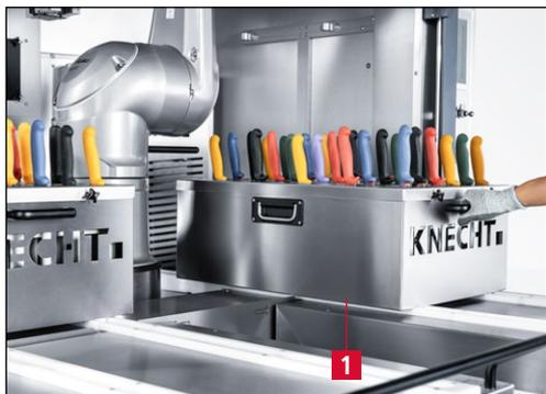
Figure 7-3 Insérer les magasins à couteaux dans l'affûteuse
