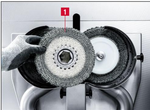
**Figure 7-29** Retirer l'anneau de démorfilage usagé
