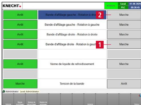
**Figure 7-18** Fonctions manuelles de la «bande d'affûtage»
