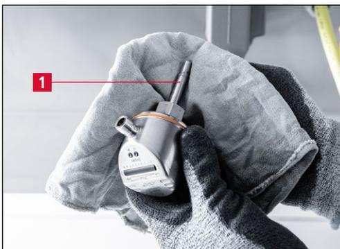
Figure 9-8 Nettoyer la sonde de mesure
