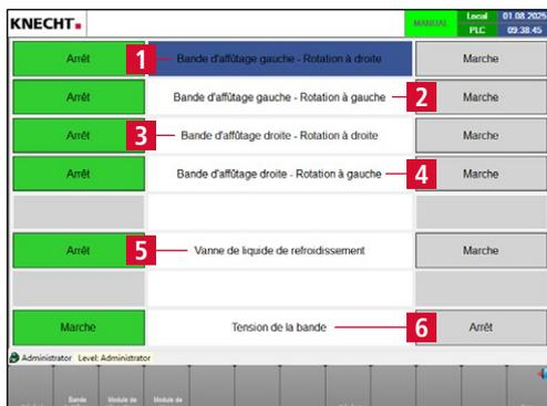
**Figure 8-9** Fonctions manuelles de la «bande d'affûtage»
