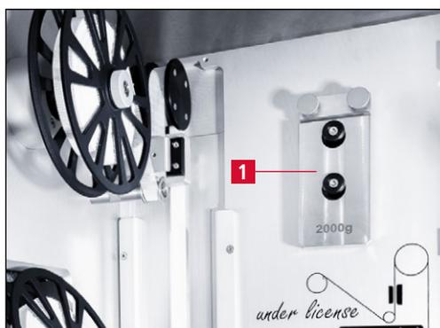
Figure 7-65 Retirer le poids d'étalonnage
