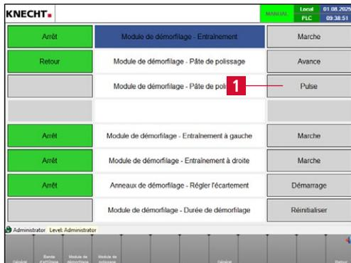
Figure 7-34 Appliquer la pâte de polissage
