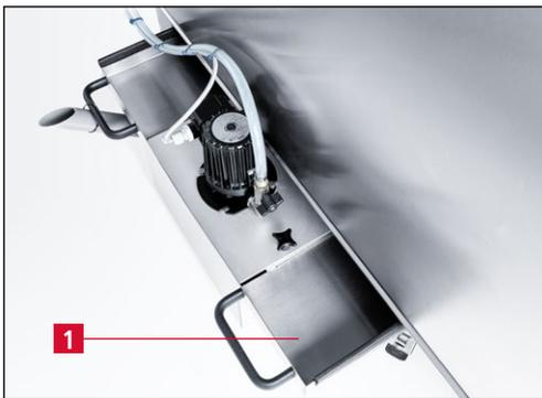
Figure 6-1 Réservoir d'eau
