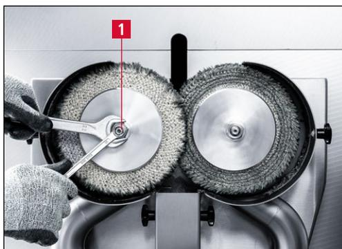
Figure 7-23 Dévisser l'écrou de serrage gauche
