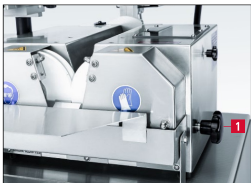
7-84 pav. Šlifavimo diskų atidarymas
