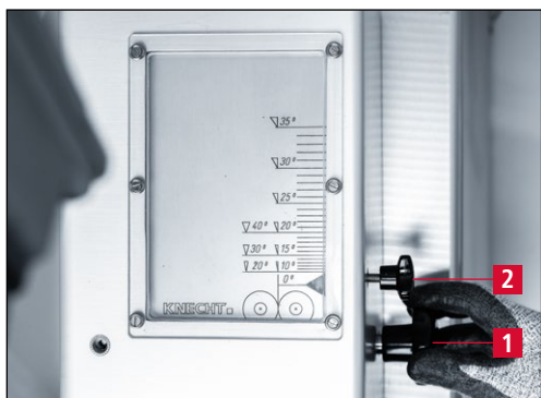
7-2 pav. Indikatoriaus fiksavimas
