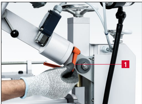
7-52 pav. Prispaudimo svirties „Laikiklio svirtis“ atlaisvinimas
