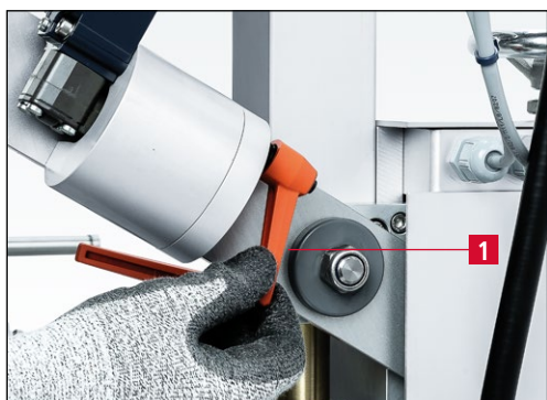
7-61 pav. Prispaudimo svirties „Laikiklio svirtis“ atlaisvinimas
