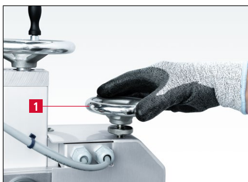
7-71 pav. Pasukite rankinį ratuką „Tikslus reguliavimas“ prieš laikrodžio rodyklę
