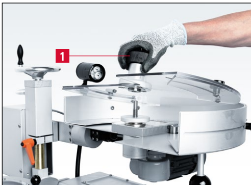
7-12 pav. Įtempiklio veržlės su apsauginiu disku nuėmimas
