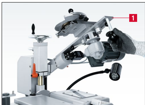
7-60 pav. Diskinio peilio šlifavimo įtaiso spaudimas į viršų
