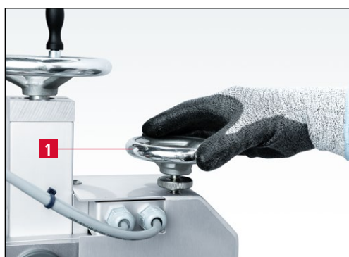
7-30 pav. Pasukite rankinį ratuką „Tikslus reguliavimas“ prieš laikrodžio rodyklę
