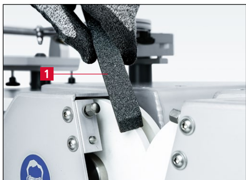
7-89 pav. Šlifavimo diskų užapvalinimas
