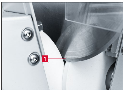
7-27 pav. Peilio atitraukimas nuo šlifavimo diskų
