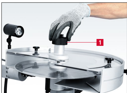
7-18 pav. Apsauginio disko uždėjimas
