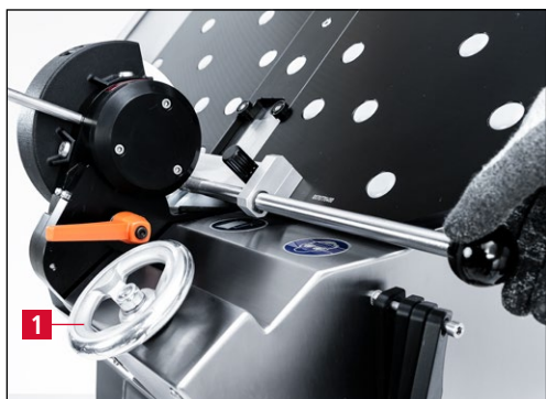
Obrázok 7-34 Orovňavanie brúsnych kotúčov
