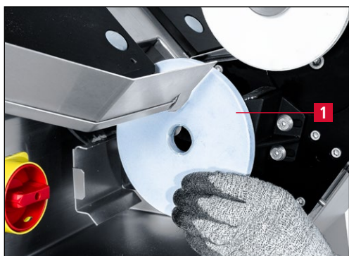
Obrázok 7-50 Odstránenie brúsnych kotúčov a nahradenie novými
