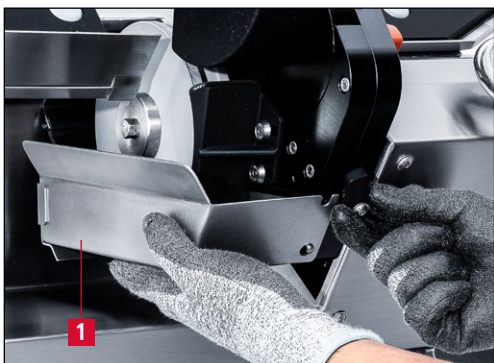
Obrázok 7-52 Montáž zásobníka na vodu
