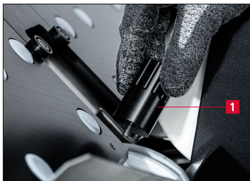
Obrázok 7-4 Montáž nastavovacieho dorazu
