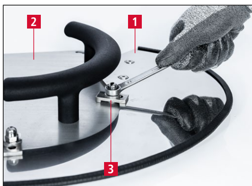
Obrázok 7-3 Upínanie kosákového noža na kopírovaciu brúsnu dosku
