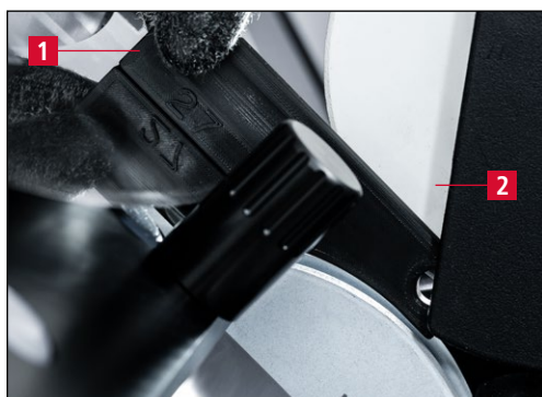
Obrázok 7-13 Priloženie šablóny na meranie uhlov
