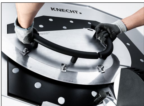
Obrázok 7-8 Umiestnenie kosákového noža do požadovanej polohy
