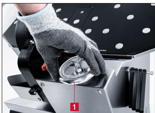
Obrázok 6-1 Presun brúsneho agregátu do hornej koncovej polohy
