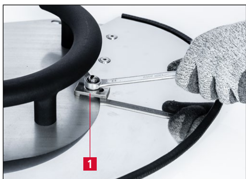
Obrázok 7-25 Uvoľnenie kosákového noža
