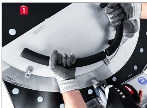
Obrázok 7-18 Posunutie kosákového noža smerom nahor
