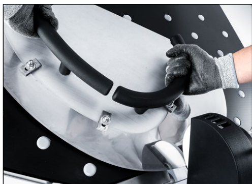
Obrázok 7-21 Ostrenie kosákového noža
