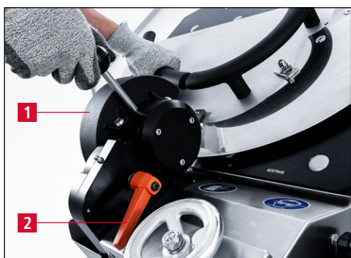
Obrázok 7-17 Umiestnenie odihlovacieho kotúča do brúsnej polohy
