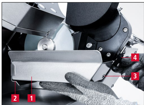
Obrázok 6-3 Montáž zásobníka na vodu
