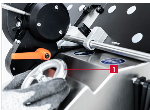
Obrázok 7-33 Presun brúsneho agregátu do orovňavacej polohy
