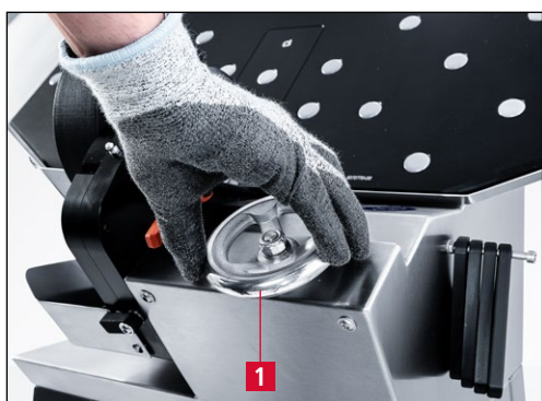
Obrázok 7-41 Presun brúsneho agregátu do hornej koncovej polohy
