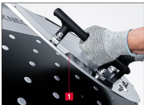
Obrázok 7-24 Odstránenie kopírovacej brúsnej dosky s nožom
