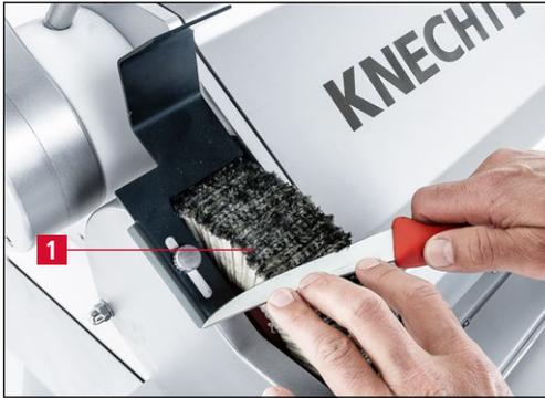
**Figure 7-138** Démorfilage et polissage du couteau à main
