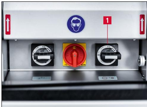
**Figure 7-133** Mise à l'arrêt du moteur d'affûtage
