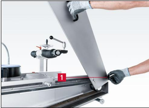
**Figure 7-149** Fermeture du capot de protection de la bande
