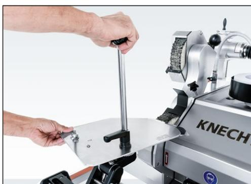
**Figure 7-129** Polissage du bombage du couteau
