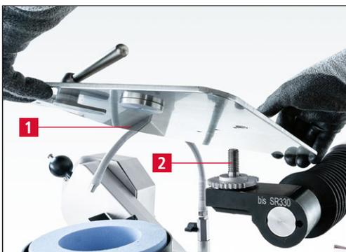
Figure 7-75 Monter le plateau d'affûtage
