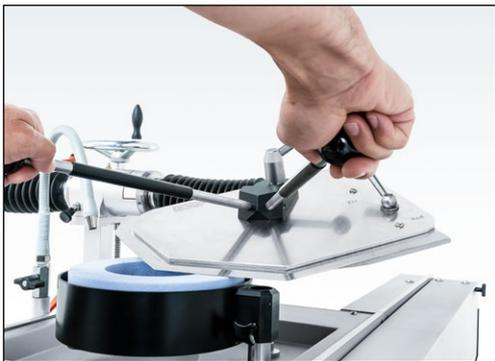
**Figure 7-92** Pivoter le couteau de cutter sur le segment de coupe suivant et l'affûter
