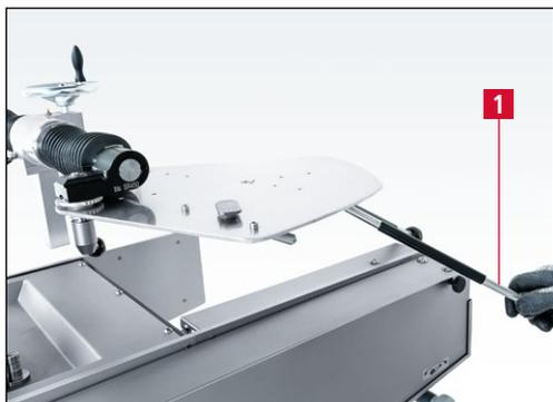
**Figure 7-16** Basculement du plateau d'affûtage vers l'arrière
