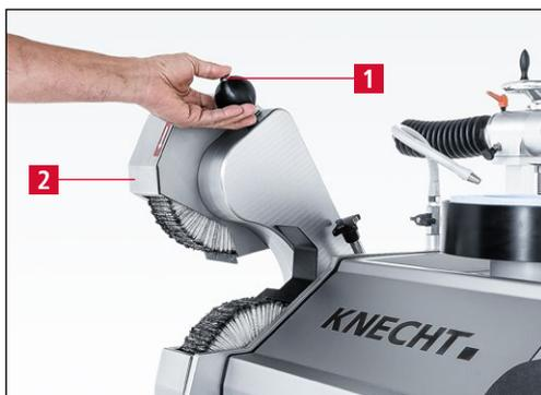
**Figure 7-64** Amener l'unité de polissage supérieure en position de travail
