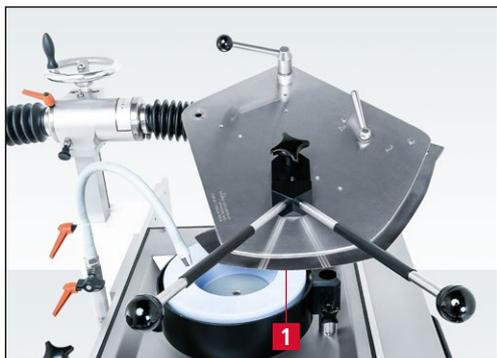
**Figure 7-19** Position du couteau sur le disque d'affûtage
