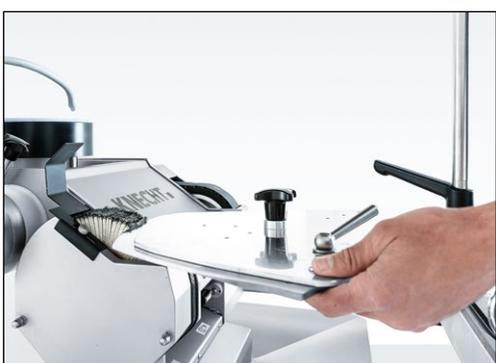
**Figure 7-62** Polissage du bombage du couteau
