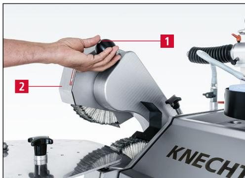
**Figure 7-60** Pivoter l'unité de polissage supérieure vers le haut
