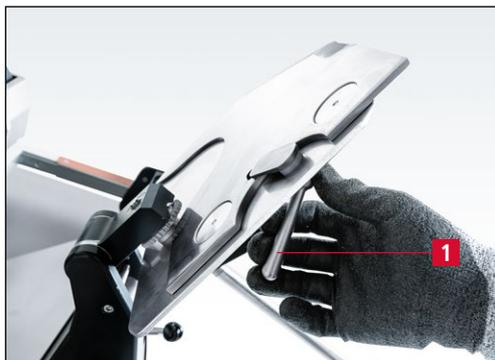
**Figure 7-107** Blocage du couteau sur le plateau d'affûtage
