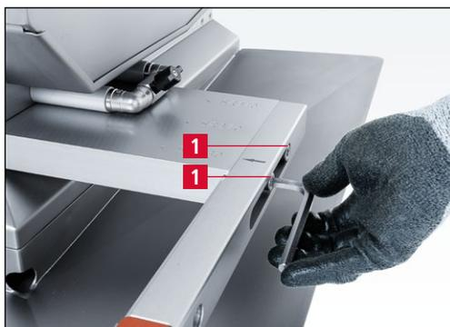
**Figure 7-30** Desserrer les vis M10
