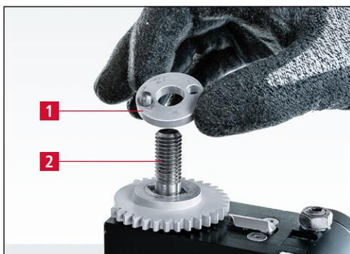
Figure 7-36 Réglage de l'angle d'affûtage
