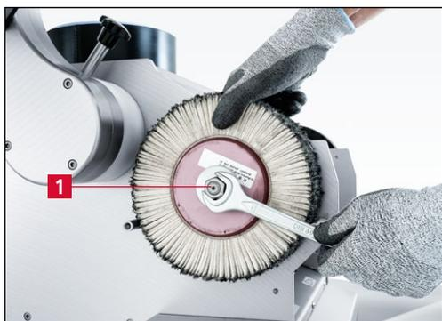
**Figure 7-152** Remplacement de la brosse à lamelles
