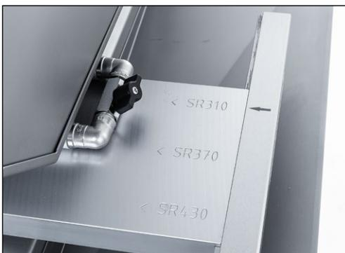
**Figure 7-94** Position réglée de l'affûteuse-polisseuse
