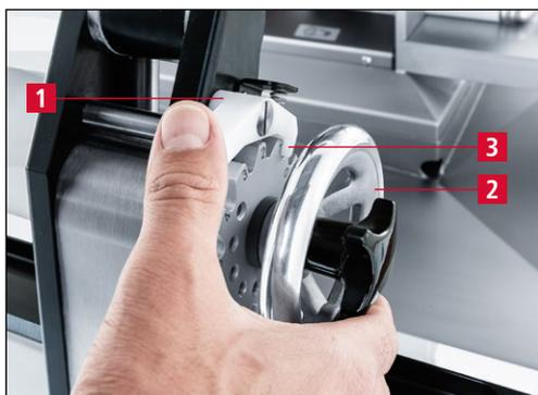
Figure 7-49 Pivotement de l'affûteuse en position d'affûtage «1»
