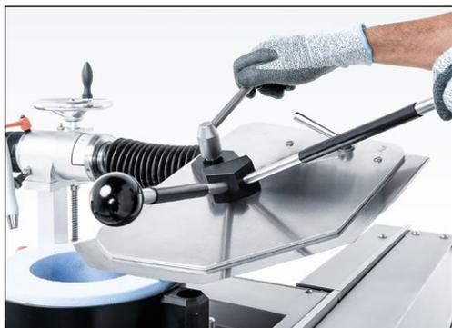
Figure 7-85 Alignement du couteau sur le disque d'affûtage
