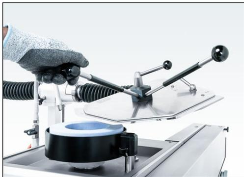
**Figure 7-81** Pivoter le plateau d'affûtage vers l'avant
