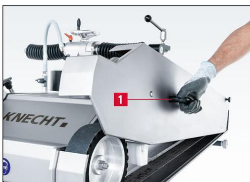
Figure 7-146 Ouverture du capot de protection de la bande
