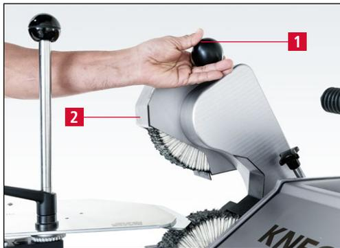
**Figure 7-127** Pivoter l'unité de polissage supérieure vers le haut
