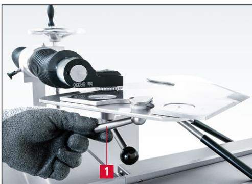
**Figure 7-80** Bloquer le couteau sur le plateau d'affûtage
