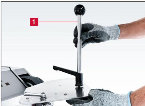
Figure 7-104 Montage du plateau d'affûtage
