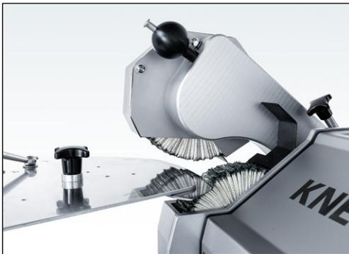
**Figure 7-58** Distance entre les brosses à lamelles env. 20 mm
