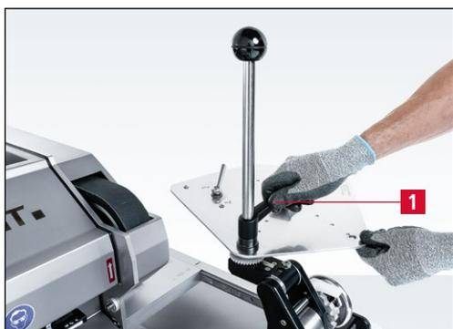
**Figure 7-39** Réglage de la plage de pivotement
