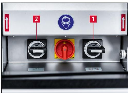
Figure 7-116 Mise en marche du moteur d'affûtage et du dispositif d'arrosage
