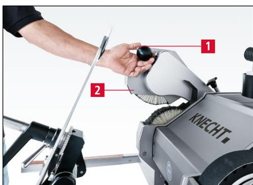
**Figure 7-131** Amener l'unité de polissage supérieure en position de travail
