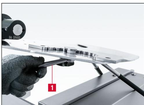
**Figure 7-18** Blocage du couteau sur le plateau d'affûtage
