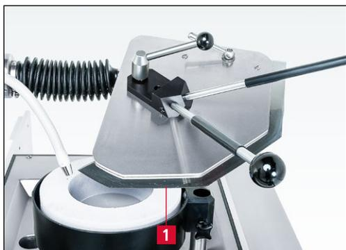
**Figure 7-82** Position du couteau sur le disque d'affûtage
