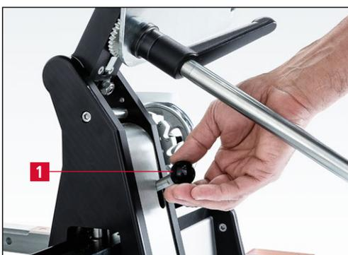
Figure 7-56 Ouverture du blocage sur le chariot
