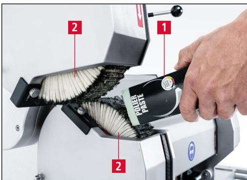
Figure 7-122 Application de pâte de polissage
