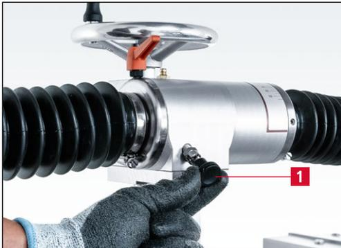
Figure 7-73 Encliquetage du boulon d'arrêt
