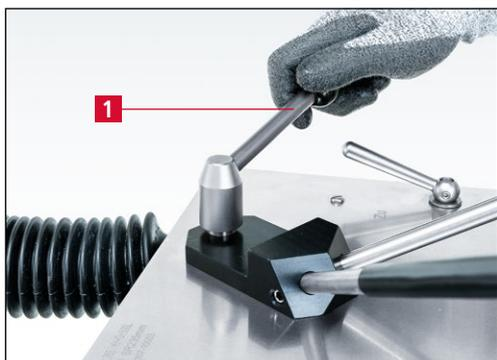
Figure 7-86 Serrage du levier de serrage
