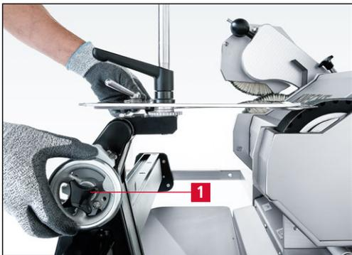
**Figure 7-112** Déplacer l'affûteuse vers la bande d'affûtage
