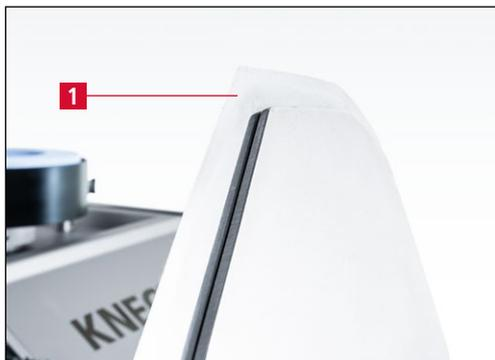
**Figure 7-134** Contrôle de l'affûtage du couteau
