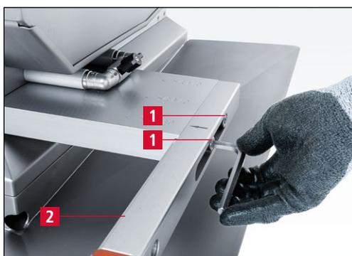
**Figure 7-96** Desserrage de la vis M10
