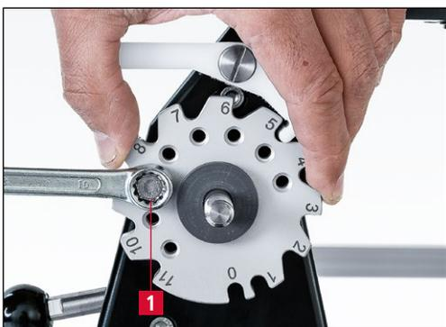
**Figure 7-53** Vis de butée
