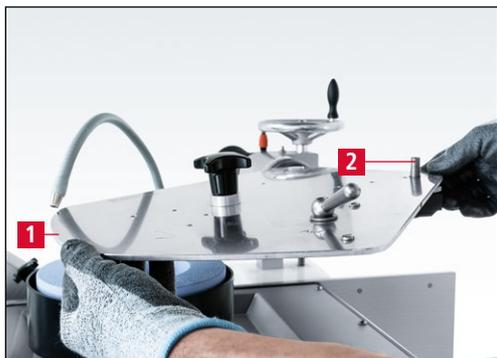
Figure 7-8 Montage du plateau d'affûtage
