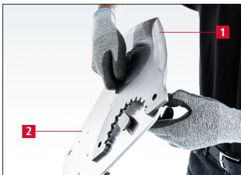
**Figure 7-41** Serrage du couteau sur le plateau d'affûtage
