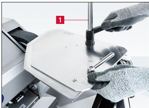
Figure 7-115 Serrage du levier d'affûtage
