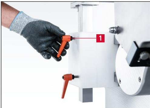
Figure 7-87 Desserrage du levier de blocage
