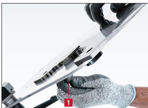
**Figure 7-42** Blocage du couteau sur le plateau d'affûtage
