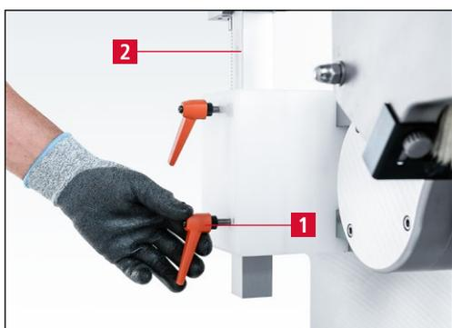
**Figure 7-20** Réglage du couteau sur le disque d'affûtage
