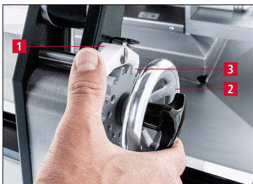
Figure 7-117 Amener l'affûteuse en position d'affûtage «1»
