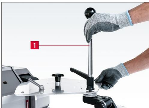
**Figure 7-38** Serrer légèrement le levier d'affûtage
