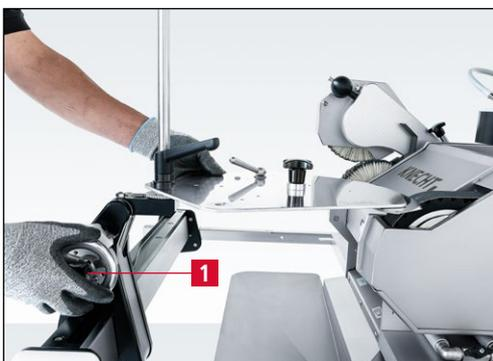
**Figure 7-47** Déplacement de l'affûteuse vers la bande d'affûtage
