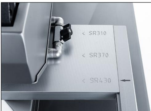
**Figure 7-28** Position réglée de l'affûteuse-polisseuse
