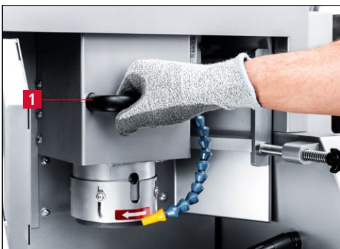
Bild 7-42 Schleifaggregat in Arbeitsposition bringen
