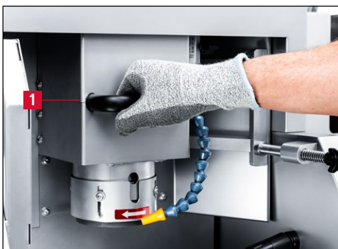
Bild 7-26 Schleifaggregat in Arbeitsposition bringen
