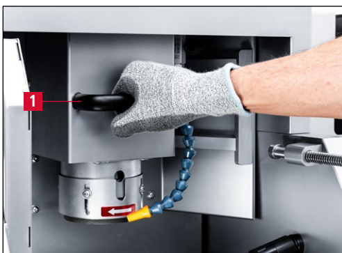
Bild 7-2 Schleifaggregat nach hinten schieben
