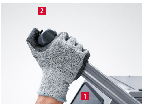
Bild 7-16 Schleifaggregat nach oben bewegen
