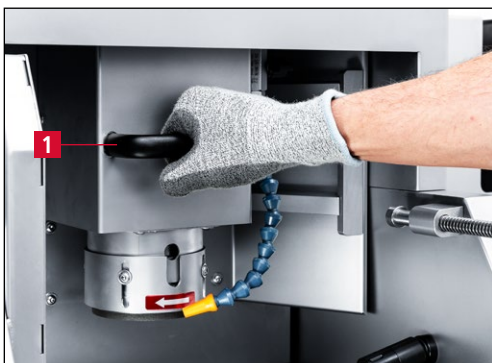
Bild 7-19 Schleifaggregat nach hinten schieben
