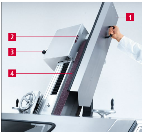
Figure 7-17 Remplacement de la bande d'affûtage à eau
