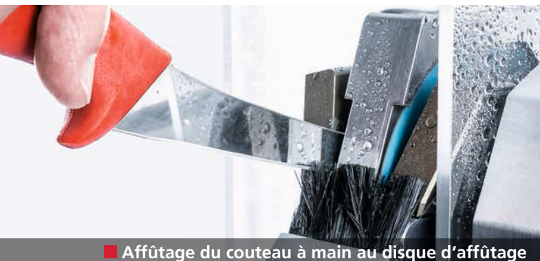
■ Démorfilage et polissage du couteau à main
