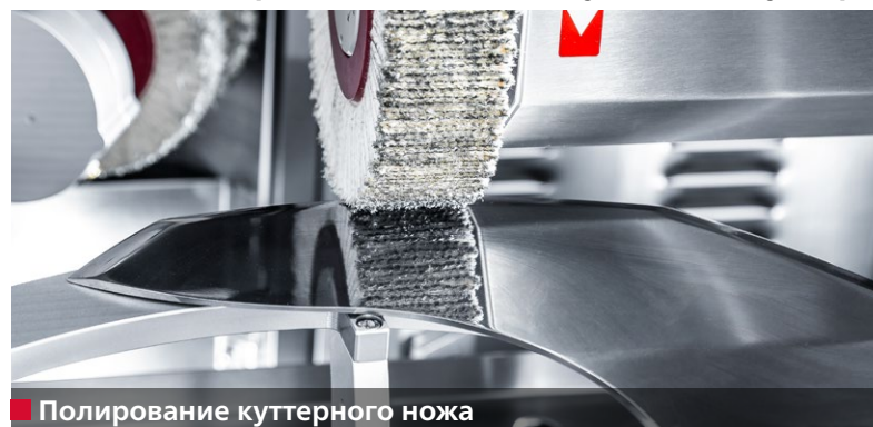
■ Снятие заусенцев с куттерного ножа
