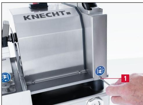
Bild 7-13 Polierscheibenabdeckung lösen
