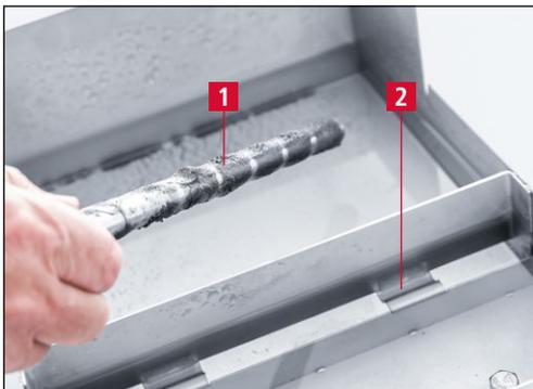
**Bild 6-1** Magnetstab einlegen
