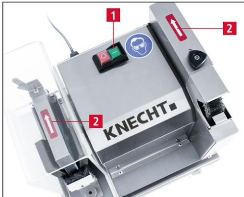
**Bild 6-3** Drehrichtung prüfen
