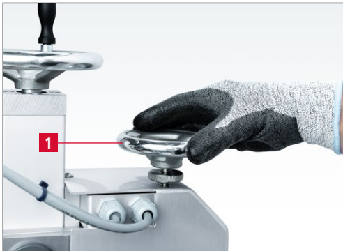
Bild 7-71 Handrad „Feinzustellung“ gegen den Uhrzeigersinn drehen
