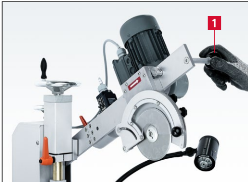
Bild 7-74 Schleifeinrichtung in die Ruheposition bringen
