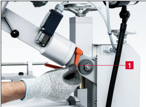
Bild 7-52 Klemmhebel „Aufnahmearm“ lösen
