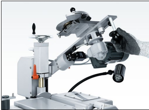
Bild 7-77 Kreismesserschleifeinrichtung in die Aufspannposition bringen
