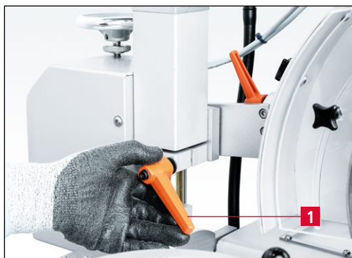
Bild 7-24 Klemmhebel „Höhenverstellung“ lösen
