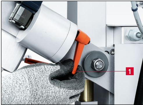
Bild 7-20 Klemmhebel „Aufnahmearm“ lösen
