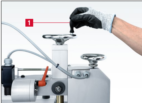
Bild 7-66 Kreismesser an die Schleifscheiben fahren
