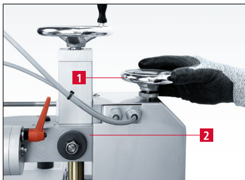
Bild 7-23 Aufnahmearm horizontal ausrichten
