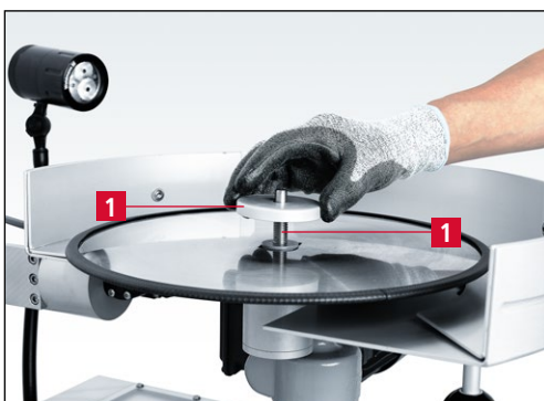
Bild 7-16 Spannflansch auf Aufnahmebolzen stecken
