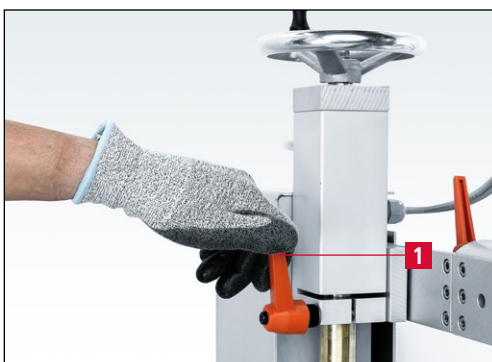
Bild 7-65 Klemmhebel „Höhenverstellung“ lösen
