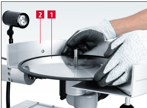
Bild 7-15 Kreismesser auf Kreismesseraufnahme legen
