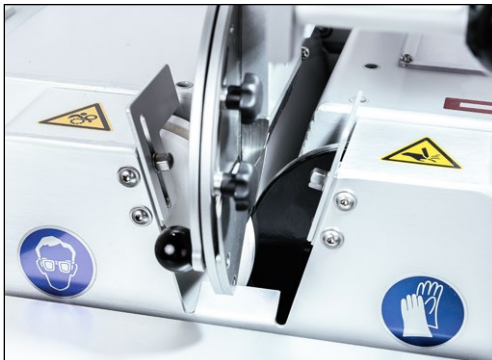
Bild 7-81 Verwendung einer gehärteten Stahlscheibe
