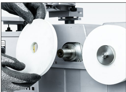
Bild 7-98 Schleifscheiben abnehmen und durch neue ersetzen
