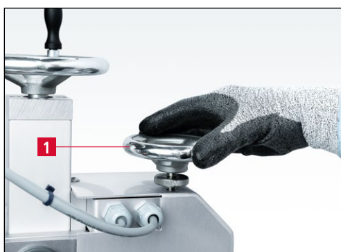
Bild 7-30 Handrad „Feinzustellung“ gegen den Uhrzeigersinn drehen
