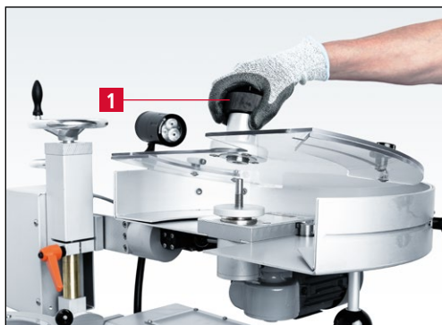
Bild 7-12 Spannmutter mit Schutzscheibe abnehmen
