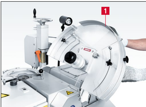
Bild 7-10 Kreismesserschleifeinrichtung im Uhrzeigersinn schwenken
