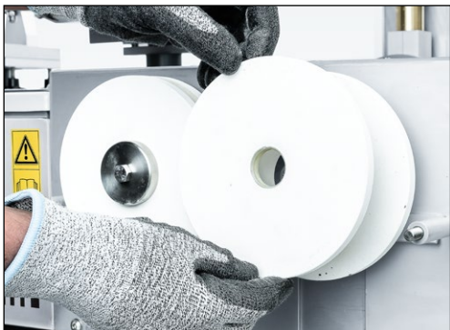
Bild 7-96 Schleifscheiben abnehmen und durch neue ersetzen
