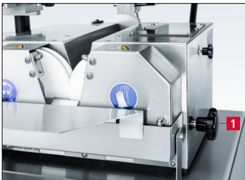
Bild 7-94 Wechselposition der Schleifscheiben
