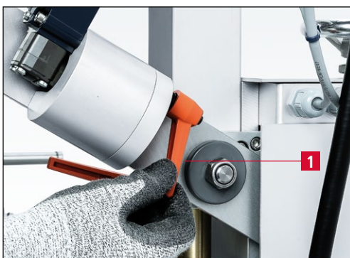
Bild 7-61 Klemmhebel „Aufnahmearm“ lösen
