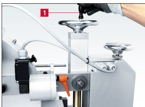
Bild 7-25 Kreismesser an die Schleifscheiben fahren
