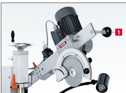
Bild 7-62 Kreismesserschleifeinrichtung in die Schleifposition schwenken
