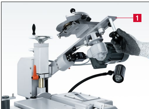
Bild 7-60 Kreismesserschleifeinrichtung nach oben drücken
