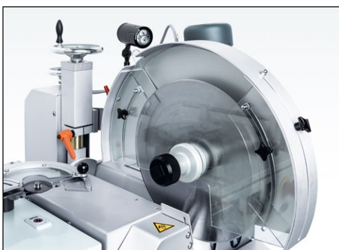
Bild 7-22 Kreismesserschleifeinrichtung in Schleifposition bringen
