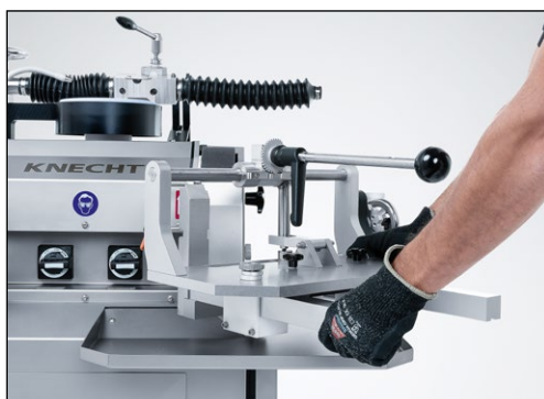
Imagen 8-2 Girar HV262 a la posición de trabajo
