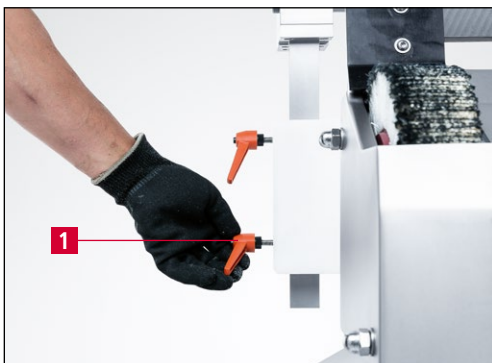
Imagen 7-13 Ajustar cuchilla en el centro de la muela abrasiva
