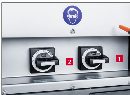
Imagen 9-19 Conectar rectificadora y dispositivo refrigerante
