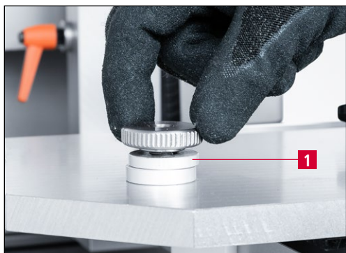
Imagen 9-29 Arandelas distanciadoras para el ajuste del ángulo de rectificación
