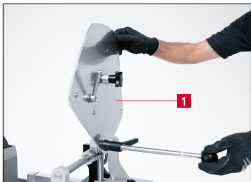
Imagen 9-35 Girar placa abrasiva hacia atrás para la protección contra torsión
