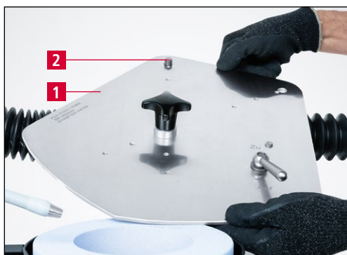
Imagen 7-34 Montar placa abrasiva
