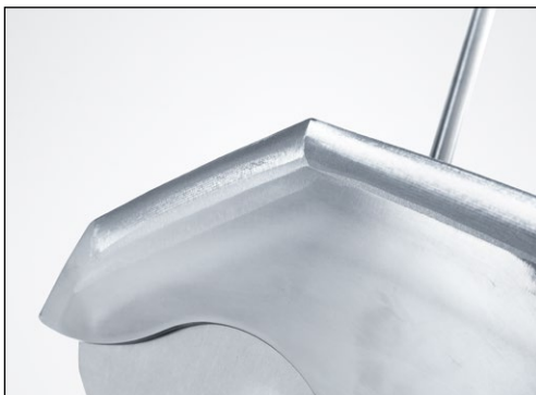
Imagen 7-26 Cutter con afilado previo abombado
