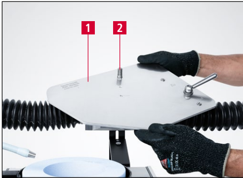
Imagen 7-5 Montar placa abrasiva
