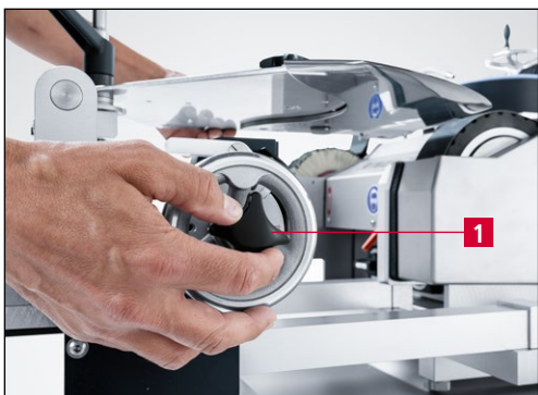
Imagen 9-48 Retraer dispositivo para rectificar
