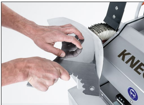
Imagen 9-26 Desbarbar y pulir cúter sobre el cepillo de láminas
