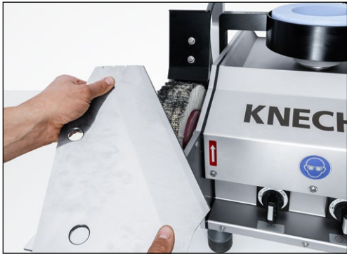
Imagen 7-21 Desbarbar y pulir cuchillas lineales sobre el cepillo de láminas
