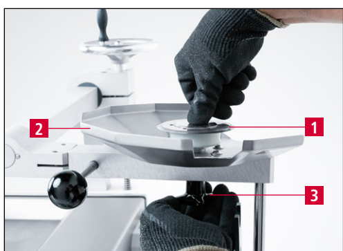
Figure 7-3 Serrage du couteau circulaire
