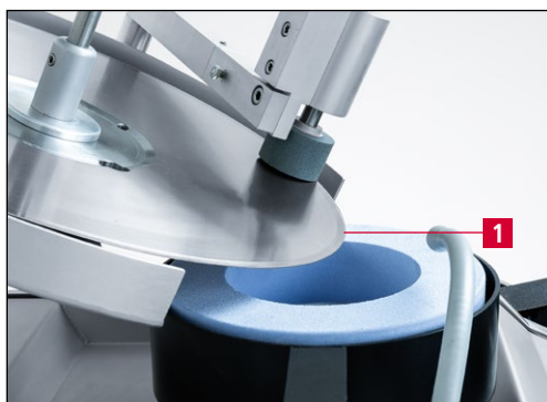
Figure 7-18 Positionnement du couteau circulaire sur le disque d'affûtage
