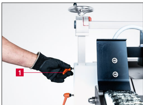
Figure 7-8 Desserrage du levier de blocage
