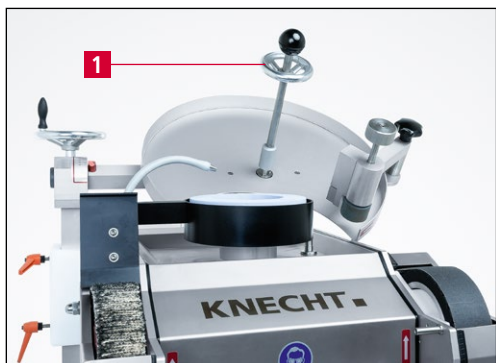
Figure 7-13 Dispositif d'affûtage pour couteaux circulaires HV205-2
