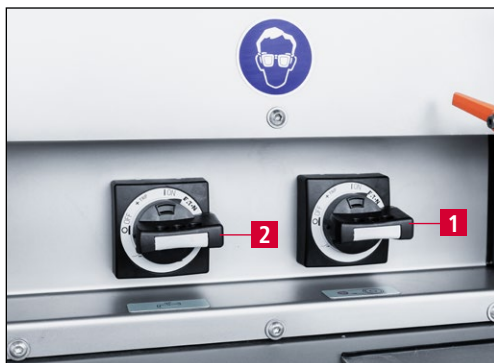
Figure 7-22 Mise en marche de l'affûteuse et du dispositif d'arrosage
