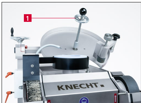
Figure 7-13 Dispositif d'affûtage pour couteaux circulaires HV 205-2
