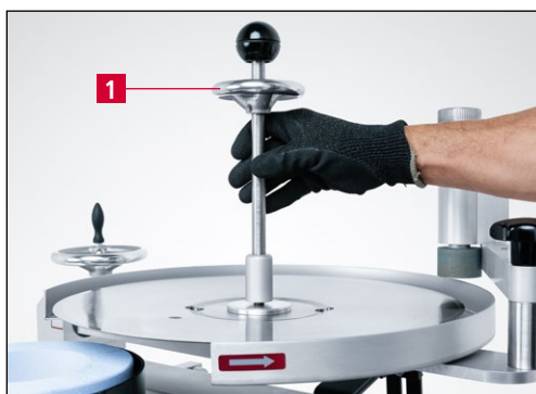
Figure 7-17 Serrage du couteau circulaire
