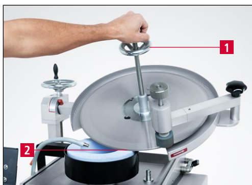
Figure 7-23 Affûtage du couteau circulaire
