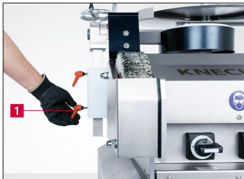
Figure 7-19 Réglage du dispositif d'affûtage pour couteaux circulaires
