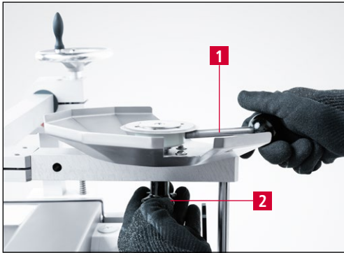
Figure 7-4 Fixation du couteau circulaire
