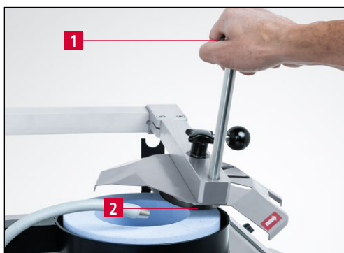
Figure 7-11 Affûtage du couteau circulaire
