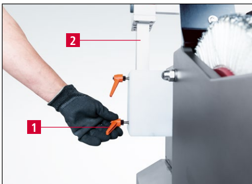
Figure 7-6 Réglage du dispositif d'affûtage pour couteaux circulaires
