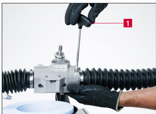
Рис. 7-29 Легкая фиксация направляющей каретки
