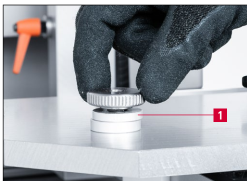
Рис. 9-29 Регулировочные шайбы для настройки угла заточки
