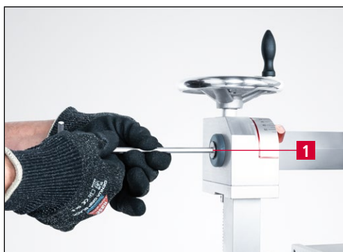
Рис. 6-1 Снятие поворотного рычага
