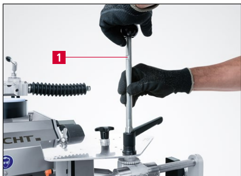
Рис. 9-32 Легкое затягивание рычага для заточки
