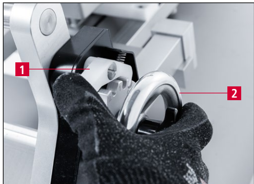
Рис. 9-40 Установка устройства для заточки в положение регулировки «0»
