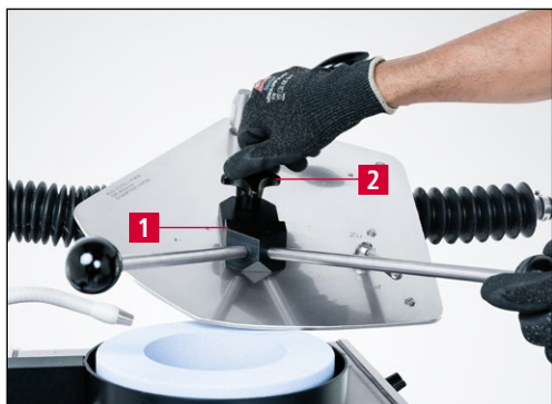
Рис. 7-37 Монтаж рычага для заточки на шлифовальной пластине
