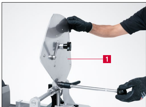
Рис. 9-35 Поворот шлифовальной пластины назад в стопор от проворачивания
