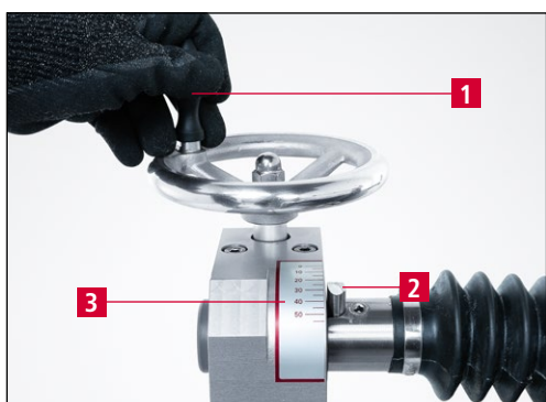
Рис. 7-18 Настройка угла заточки
