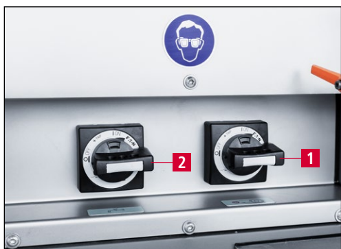
Рис. 9-43 Включение станка для заточки и системы охлаждения
