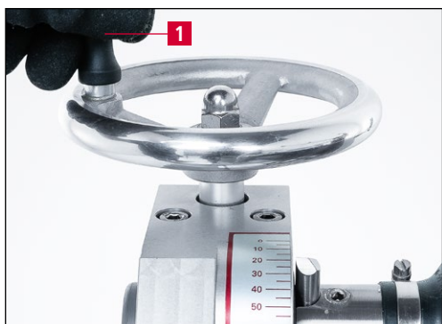
Рис. 7-48 Уменьшение угла заточки (выпуклая заточка)
