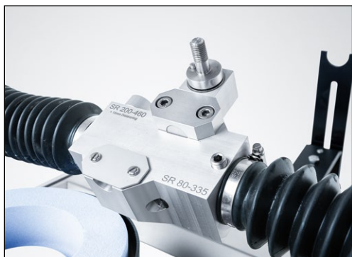
Рис. 7-28 Проверка положения зажимной головки
