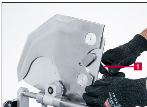
Рис. 9-10 Фиксация ножа на шлифовальной пластине
