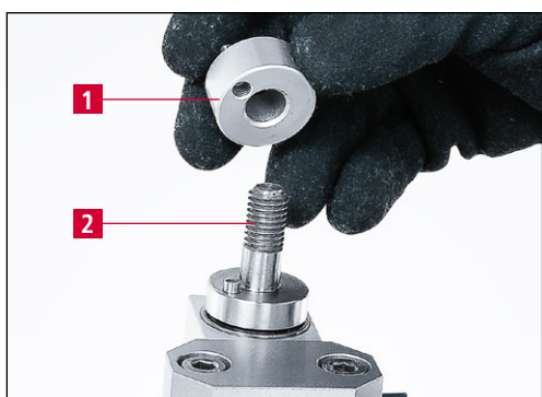
Рис. 7-33 Установка регулировочной шайбы на болт крепления
