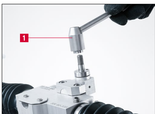
Рис. 7-4 Снятие зажимного рычага
