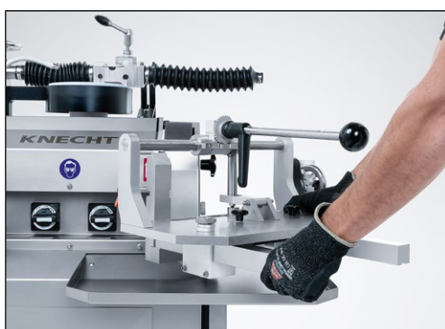
Рис. 8-2 Поворот устройства HV 262 в рабочее положение
