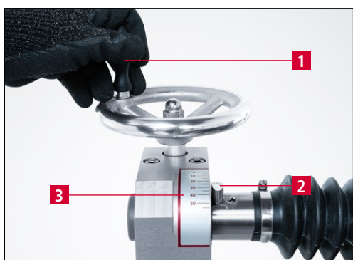
Рис. 7-45 Настройка угла заточки
