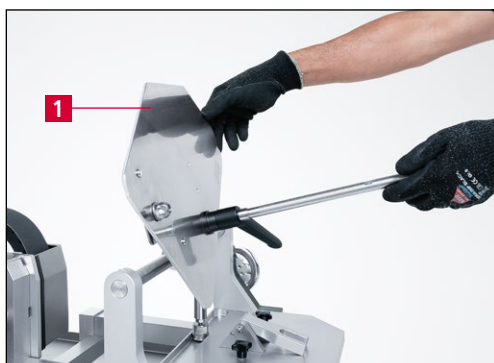
Рис. 9-8 Поворот шлифовальной пластины назад
