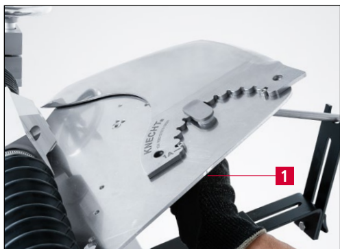
Рис. 7-41 Фиксация ножа на шлифовальной пластине
