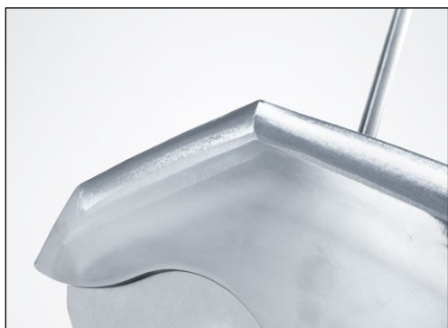
Рис. 7-26 Куттерный нож с предварительной выпуклой заточкой
