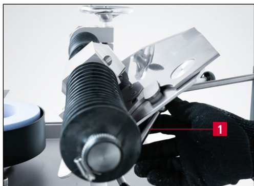
Рис. 7-10 Фиксация ножа на шлифовальной пластине
