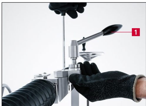
Рис. 7-1 Монтаж неподвижной зажимной головки
