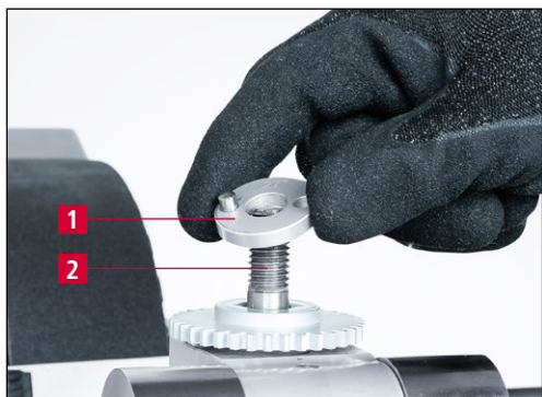
Рис. 9-30 Настройка угла заточки
