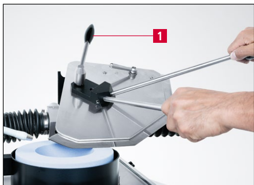
Рис. 7-25 Поворот куттерного ножа на следующий сегмент режущей кромки
