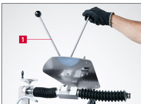
Рис. 7-39 Поворот шлифовальной пластины назад
