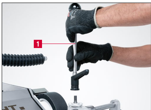
Рис. 9-2 Снятие рычага для заточки
