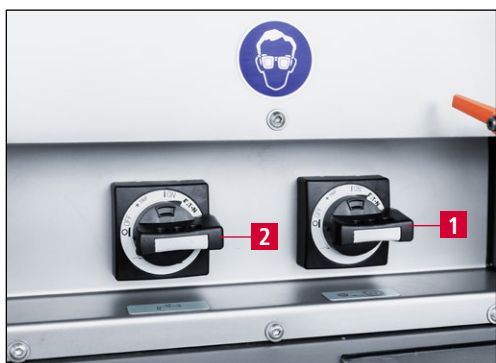
Рис. 9-19 Включение станка для заточки и системы охлаждения
