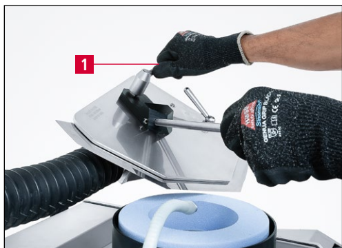
Рис. 7-14 Ослабление зажимного рычага
