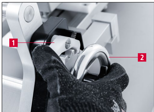
Рис. 9-13 Установка устройства для заточки в положение регулировки «0»
