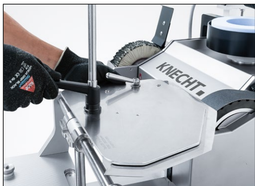
Рис. 9-17 Выравнивание ножа на шлифовальной ленте
