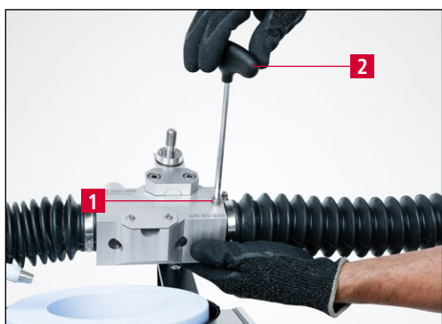
Рис. 7-32 Затягивание зажимного болта
