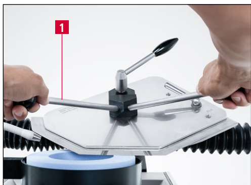
Рис. 7-23 Заточка линейных куттерных ножей
