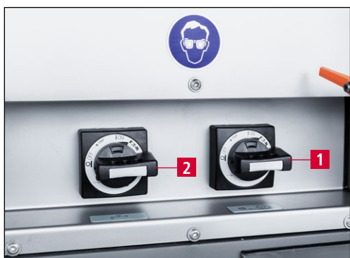
Рис. 7-19 Включение станка для заточки и системы охлаждения
