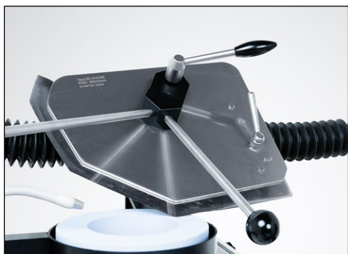
Рис. 7-11 Поворот шлифовальной пластины вперед
