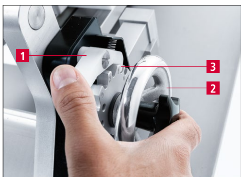
Рис. 9-20 Установка устройства для заточки в положение заточки «1»
