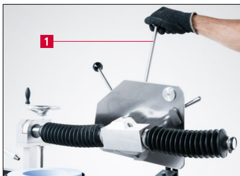
Рис. 7-8 Поворот шлифовальной пластины назад
