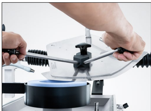
Рис. 7-49 Поворот куттерного ножа на следующий сегмент режущей кромки
