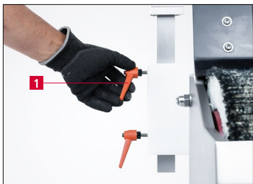
Рис. 7-17 Ослабление зажимного рычага
