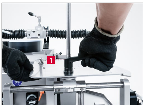
Рис. 9-18 Затягивание рычага для заточки
