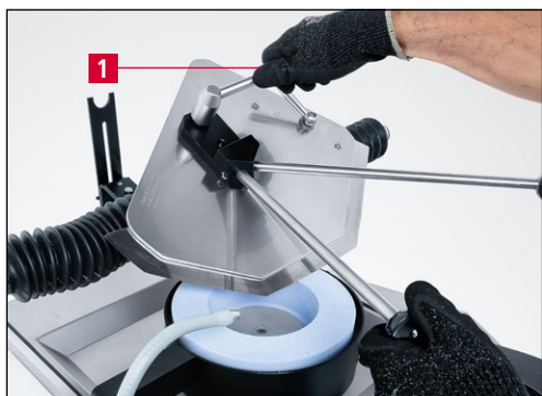
Рис. 7-16 Затяжка зажимного рычага
