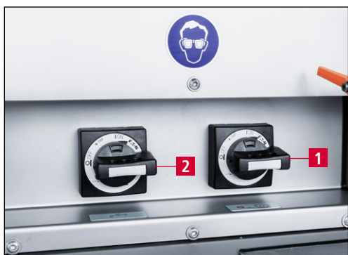
Рис. 7-46 Включение станка для заточки и системы охлаждения
