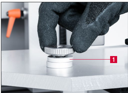
Рис. 9-4 Регулировочные шайбы для настройки угла заточки
