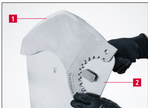
Рис. 9-36 Крепление ножа на шлифовальной пластине
