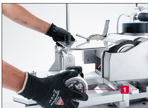
Рис. 9-15 Перемещение устройства для заточки к шлифовальной ленте
