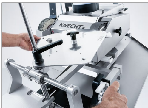
Рис. 9-42 Перемещение устройства для заточки к шлифовальной ленте
