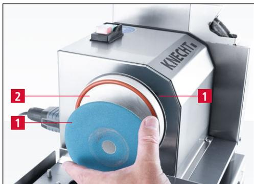
**Imagen 7-10** Desmontar las muelas abrasivas usadas
