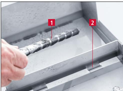
Imagen 6-1 Colocación de la barra magnética
