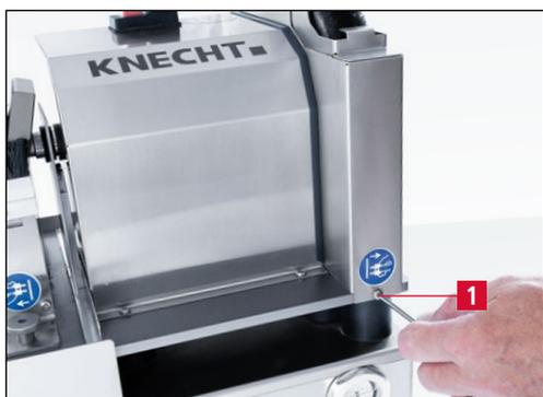
**Imagen 7-13** Aflojar la cubierta de la muela de pulir
