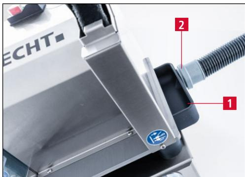
**Imagen 7-17** Cajón colector de suciedad con tubuladura de aspiración
